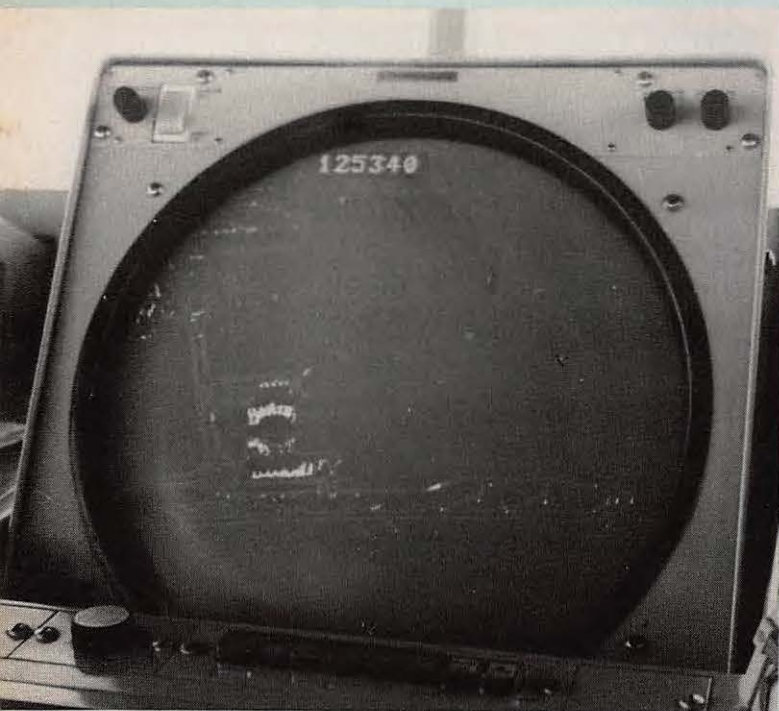
Visualisation à 12 nautiques. On voit sur l'écran radar l'aérogare n° 2 et la piste 2.
