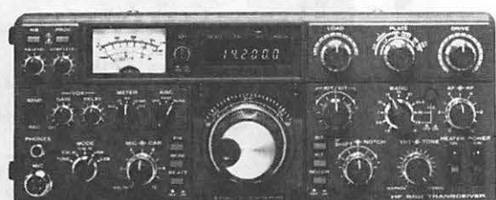
Émetteur-récepteur TS 830 S Emission-réception Bandes amateurs Tubes au final - 220 V - USB/LSB/CW.
