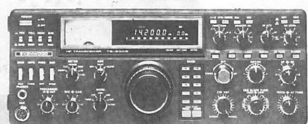
Émetteur-récepteur HF TS 930SP* Emission bandes amateurs. Réception couverture générale tout transistor. AM/FSK/USB/LSB/CW. Alimentation secteur incorporée.
