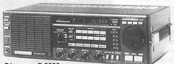
Récepteur R 2000 Couverture générale 150 KHz à 30 MHz. AM/FM/CW/BLI/BLS. 220 et 12 volts. 10 mémoires. en option convertisseur VC 10 pour recevoir de 118 à 174 MHz.
