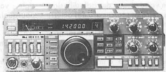
Émetteur-récepteur TS 430SP* Tout transistor. LSB/USB/CW/AM et FM en option. 100 W HF Emission bandes amateur. Réception couverture générale 12 volts.
