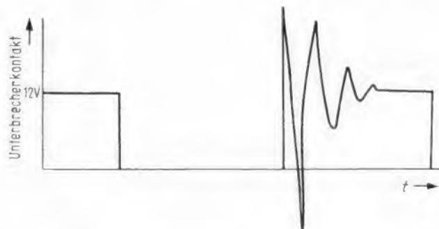
Bild 2. Am Unterbrecherkontakt treten Prellstörungen und Ausschwingvorgänge der Zündspule auf
