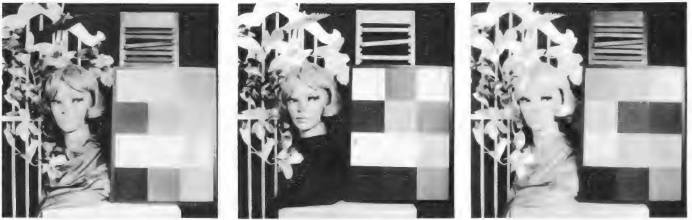
Bild 3. Schwarzweißauszüge über RGB-Filter der in Bild 2 gezeigten Vorlage. Man erkennt deutlich die unterschiedliche Schwärzung der Farben Rot – Grün – Blau in den Auszügen
