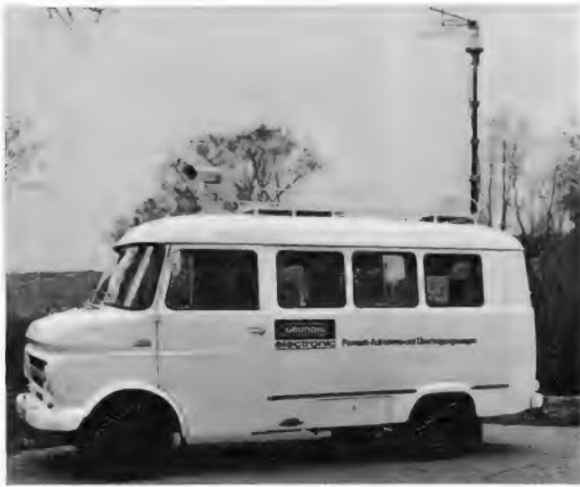
Bild 2. Von Grundig entwickelter Fernseh-Übertragungswagen für Polizeizwecke. Die Stellung der Corner-Antenne für den Bereich um 450 MHz, die „Blickrichtung“ der wetterfesten Kamera über dem Führerhaus und die Zoomlinse sind von der Fernsehzentrale im Präsidium aus über Funk fernsteuerbar
