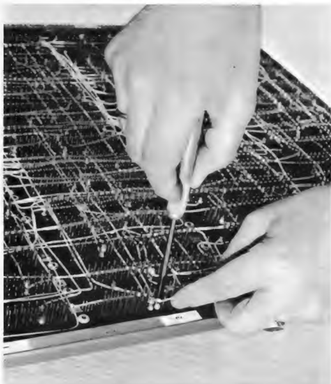
In wenigen Sekunden kann der Außendienstmonteur mit diesem nur 50 g schweren Werkzeug eine lötfreie Verbindung wickeln (Aufnahme: Deutsche Gardner-Denver GmbH)
