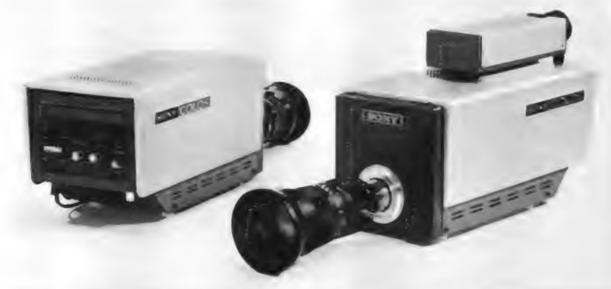
Bild 1. Die kompakte Trinicon-Kamera von Sony mit Zoom-Objektiv und (rechts) mit aufgesetztem elektronischen Sucher
