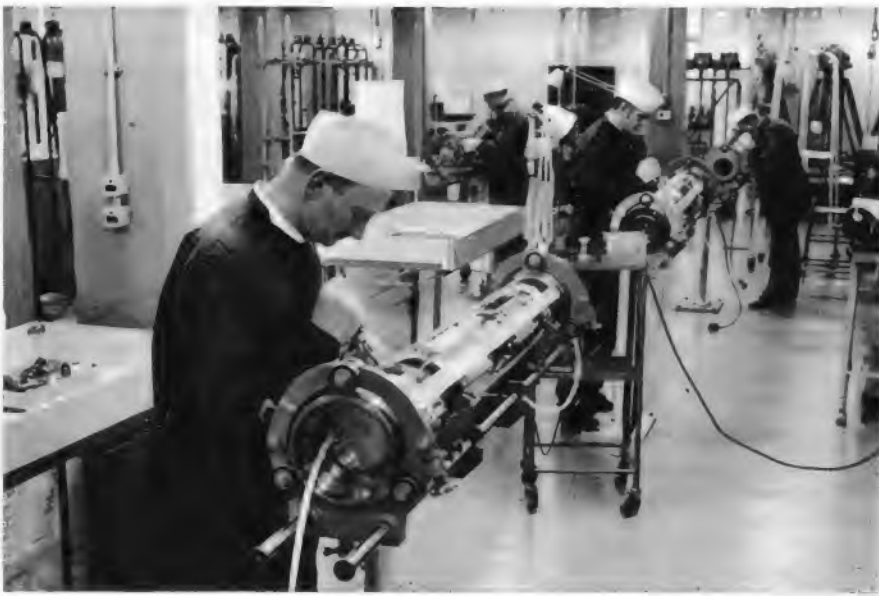
Bild 4. Verstärkerfertigung in umweltkontrollierten Räumen (Werksaufnahme: STC)
