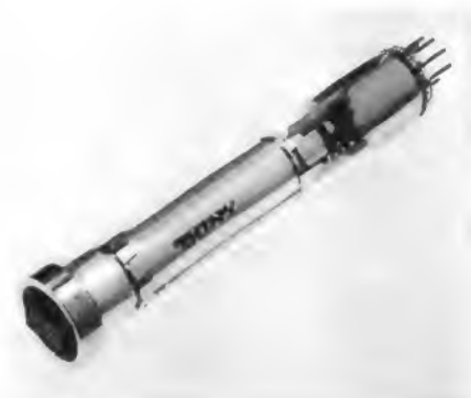
Bild 2. Die 1-Zoll-Bildwandlerröhre der Trinicon-Kamera mit aufgesetztem Farbteilersystem
