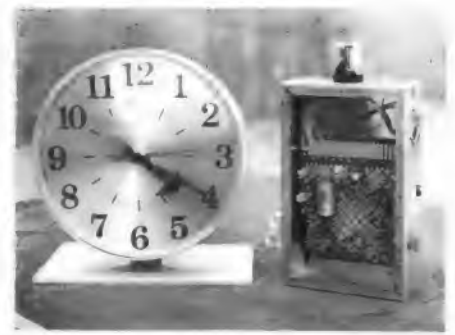
◀ Bild 4. Polwechsel-Leistungsstufe für Nebenuhren mit Impulsen wechselnder Polarität
