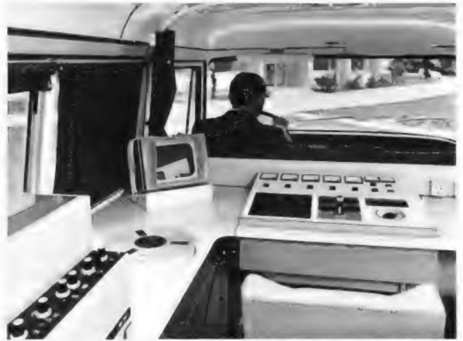
Bild 3. Blick in den vorderen Teil des Fernseh-Übertragungswagens. In der Mitte Bedienungspult mit Steuerknüppel für die Wagendachkamera, links der 21-cm-Monitor und vorn links der Videorecorder BK 300. Der 10-W-UHF-Sender befindet sich im hinteren Wagenteil neben dem Fußpunkt des Antennenmastes
