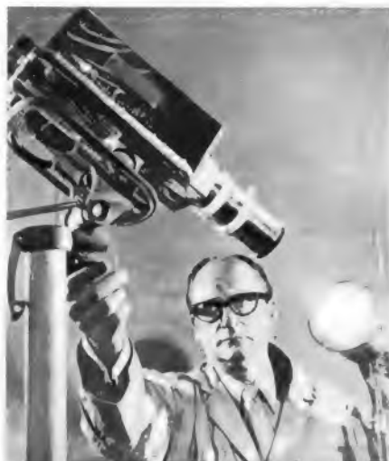
Die neue Mondkamera bei einem harten Test: Eine starke Lampe strahlt direkt in das Objektiv, um die Lichtsicherheit der SIT-Röhre zu prüfen. Aufnahme: RCA Corp.
