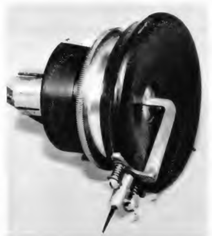
Bild 2. Ein aus einem Feldtelephonhörer gebauter elektrischer Tonabnehmer für die Schallplattenkonzerte
