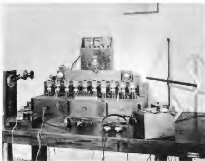
Bild 4. Regieraum der Hauptfunkstelle Königs Wusterhausen. Links das Ansegmikrofon, in der Mitte Trennverstärker mit zehn Einzelröhren für die elektromagnetischen Einzelmikrofone (siehe Bild 3), dahinter der Summenverstärker; rechts ein Detektor-Kontrollempfänger mit Rahmenantenne
