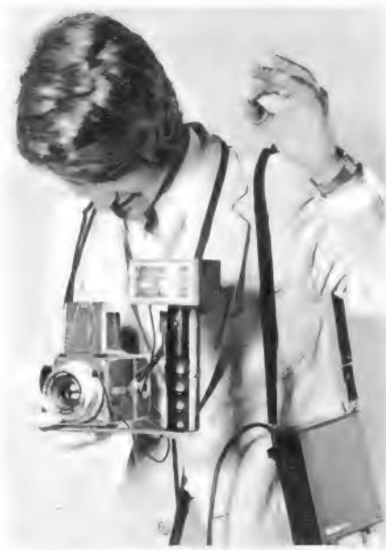
Bild 6. Professionellen Ansprüchen wird der Metz Mecablitz 202 gerecht, der neben dem Telecomputer auch mit schwenkbarem Reflektor ausgestattet ist
