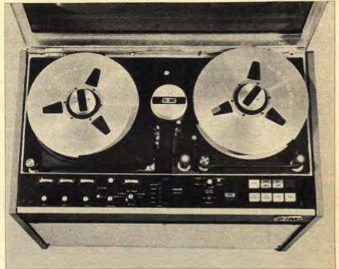
Bild 6. Studiofähiger Farbfernseh-Video-recorder, Typ IVC-900, mit Schrägspuraufzeichnung und vollständiger elektronischer Schneideeinrichtung
