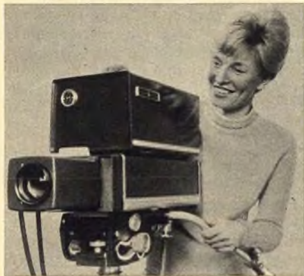
Bild 5. Diese besonders leicht zu bedienende Farbkamera von General Electric wurde mit dem Schlagwort „go anywhere – do anything“ angekündigt. Der obere Kasten enthält den leicht abnehmbaren elektronischen Sucher
