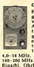
Grid-Dip-Meter TE 15 Ein Trans.-Diper mit folgenden Vorzügen: 6 Ber. von 0,44–280 MHz. Hohe Ablesegenauigkeit. Präz.-Instrument, stab. Metallgeh. Netzunabhängig d. eingeb. 9-V-Batt.-Feintrieb 1:3, Ber. 0,44 bis 1,3 MHz, 1,3–4,3 MHz, 4,0–14 MHz, 14–40 MHz, 40–140 MHz, 140–280 MHz, M.: 60 x 80 x 150 mm, Einschl. Ohrhörer 119.50
