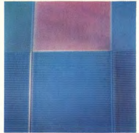
Bild 15. Zeilenstruktur im Querstreifen des Sondertestbildes als Fehlerindikation falscher Amplitudeneinstellung
