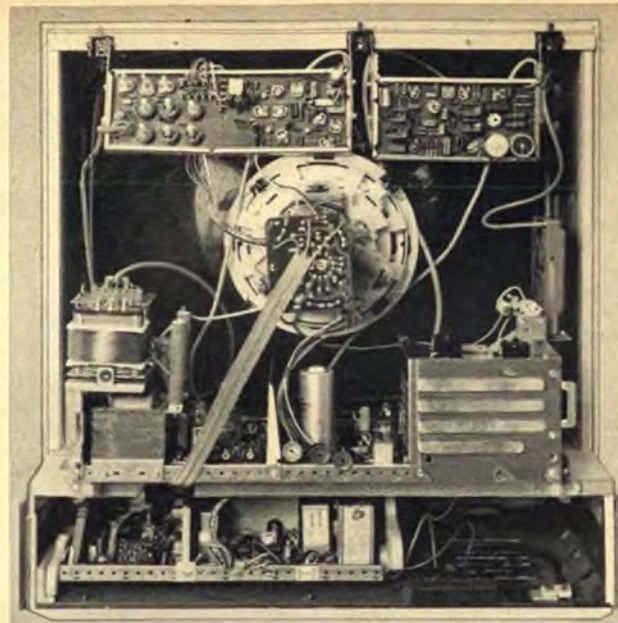
Blick in zwei Entwicklungsmuster von Farbfernsehgeräten mit 110°-Farbbildröhren. Das volltransistorisierte Empfangsteil kann sowohl neben als auch unter dem Horizontalchassis angeordnet werden
