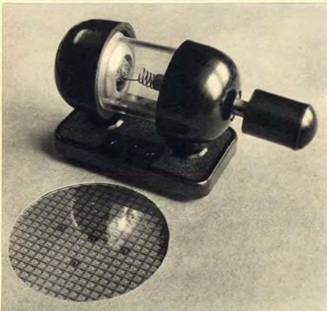
Damit fing es an. Ein einstellbarer Kristalldetektor aus der Anfangszeit des Rundfunks. Im Vordergrund eine Siliziumscheibe mit Hunderten von integrierten Schaltungen (Aufnahme: Limann)
