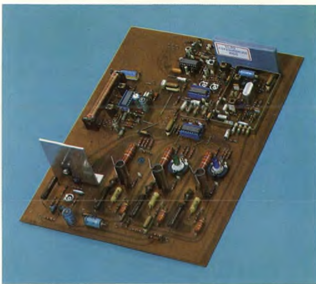
Bild 4. Laboraufbau einer Platine mit integrierten Schaltungen. Er umfaßt nicht nur den Decoder, sondern auch den Luminanzteil und die RGB-Endstufen
