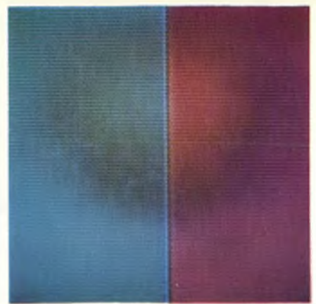
◀ Bild 16. Zeigerdiagramm bei falscher Phaseneinstellung im Pal-Decoder
