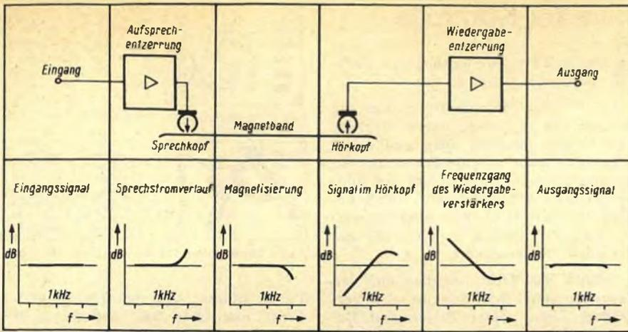
Bild 7. Entzerrung des Signals bei Aufnahme und Wiedergabe
