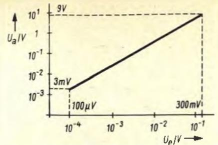
Bild 2. Die Übertragungskennlinie der Schaltung nach Bild 1
