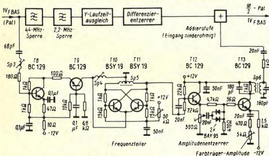
Bild 7. Gerät zur Farbträgerfrequenzhalbierung
