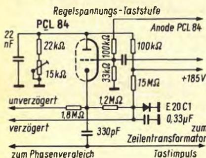
Durch den Feinschluß des Kondensators wurde die Regelspannung mehr oder minder stark belastet und sank entsprechend ab, was zwangsläufig zu einer entsprechenden Kontraständerung führte
