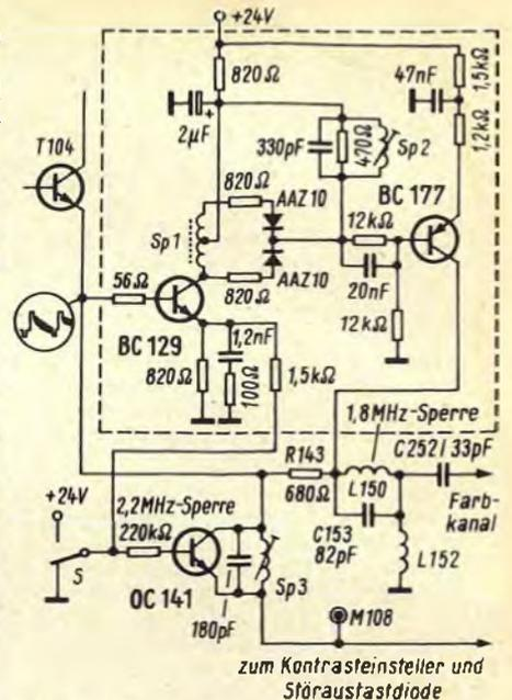
Bild 8. Farbträgerfrequenzverdoppler in einem Versuchsgarät
