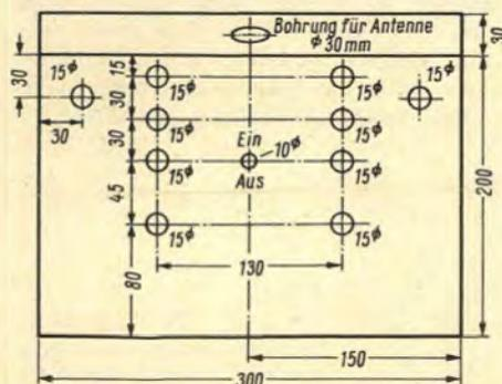
Bild 9. Maße des Sendergehäuses
