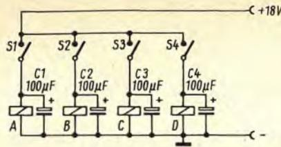
Bild 5. Die Verzögerungstufenschaltung
