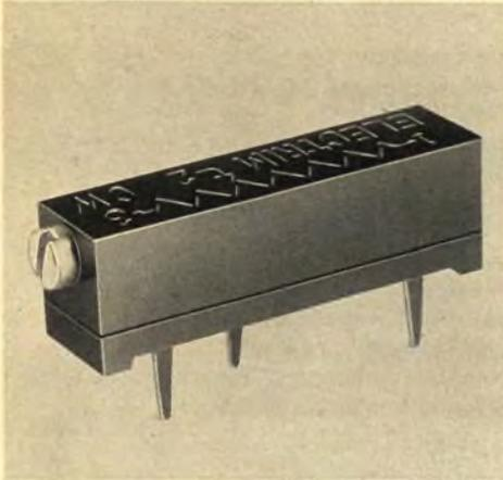
Dieses neue Trimmpotentiometer ET-34 hat ein Cermet-Widerstandselement. Dadurch ergibt sich ein großer Widerstandsbereich von 10  $\Omega$  bis 2 M $\Omega$ . Eine hohe Einstellgenauigkeit wird mittels 15 Umdrehungen und einer nahezu unendlichen Auflösung erreicht. Es besitzt ausgezeichnete Stabilität bei Schock und Vibration sowie gute NF- und HF-Eigenschaften. Dieses Trimmpotentiometer ist wasserdicht und in 3 verschiedenen Anschlußarten lieferbar.
