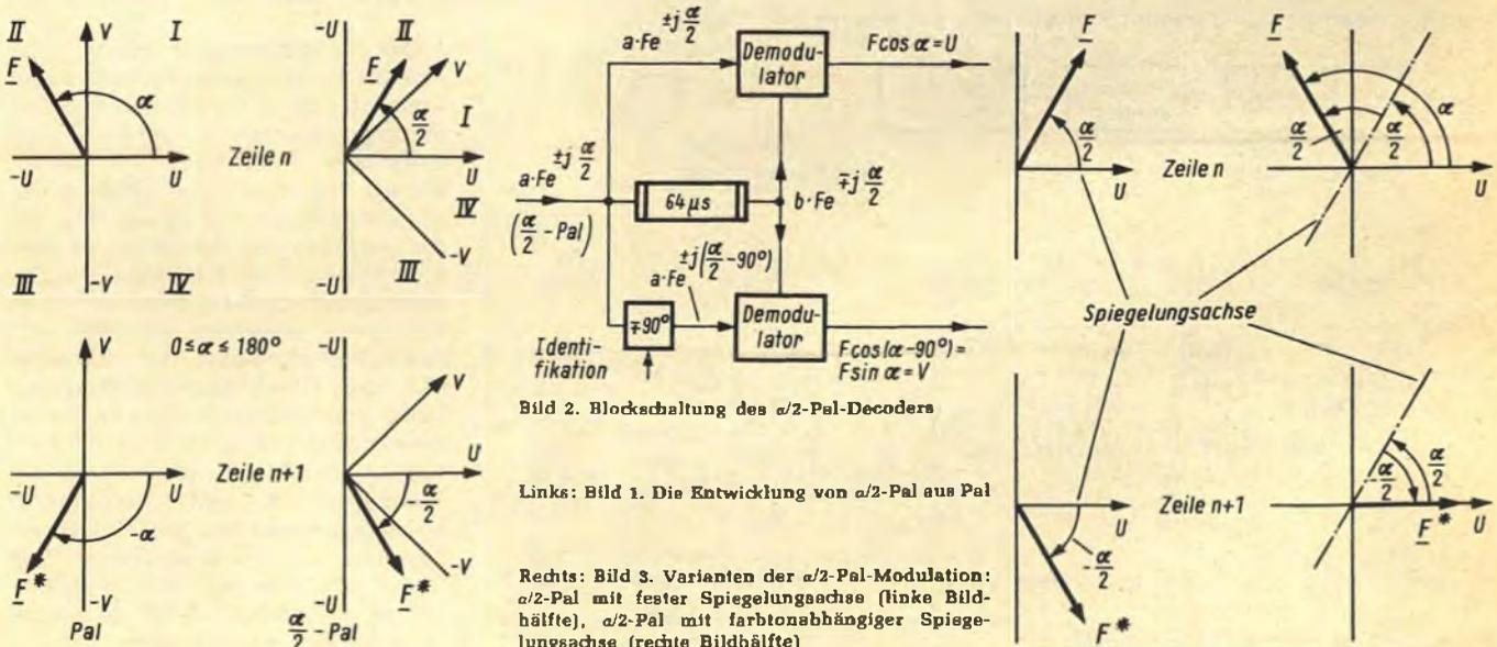
Bild 2. Blockschaltung des  $\alpha/2$ -Pal-Decoders
