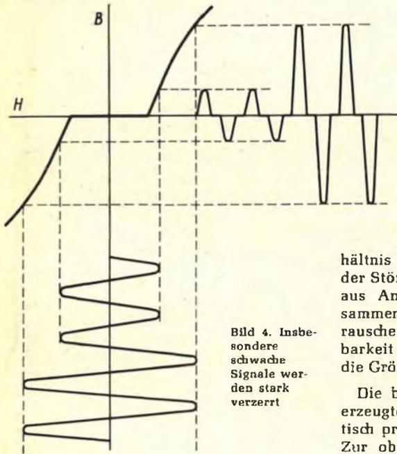
Bild 4. Insbesondere schwache Signale werden stark verzerrt
