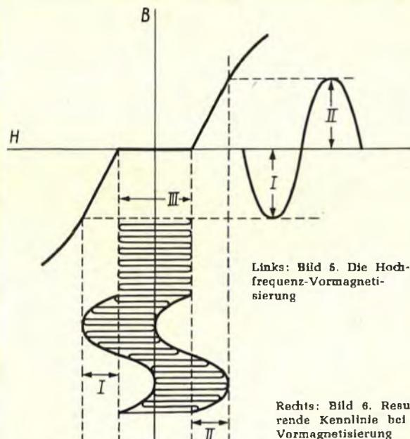
Links: Bild 5. Die Hochfrequenz-Vormagnetisierung
