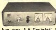
**TNG 3 Stabilisiertes Netzgerät** aus deutscher Fertigung mit Überlastungsschutz m. V- und A-Meter 0 bis 25 V, stufenlos regelbar, max. 3 A Dauerlast. Brummspannung bei 3 A, 230 mV<sub>eff</sub>. Best.: 2 N 3055, 2 N 1613, 4 x BC 107, ZL 12, 2 F 10, 1 N 814 **219.75**
