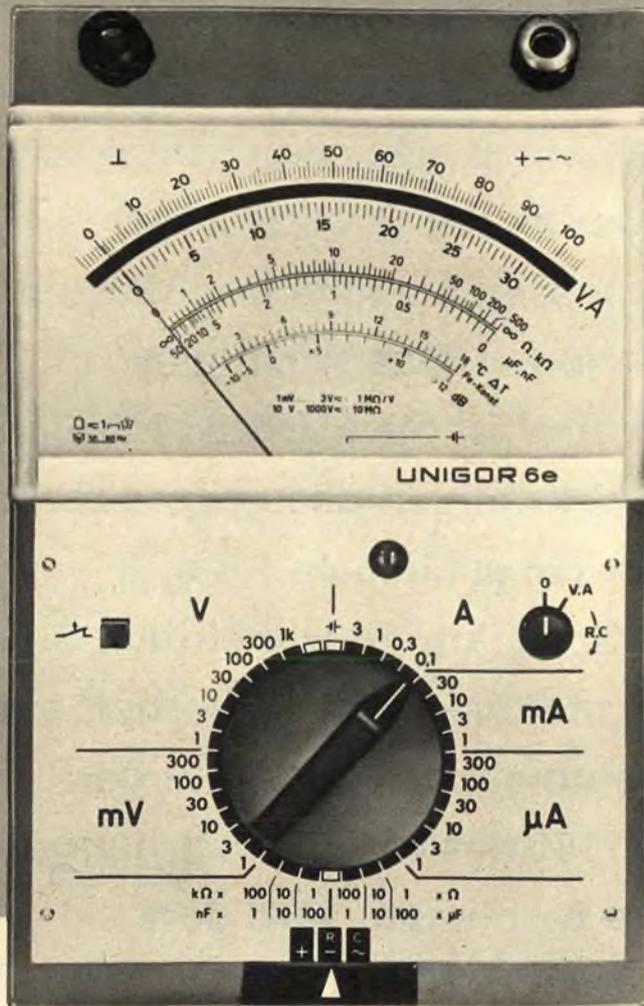
Die hohe Empfindlichkeit von  $1 \text{ M}\Omega/V$  bei Gleich- und Wechselstrom ermöglicht einen universellen Einsatz des neuen Vielfachmeßgerätes.
