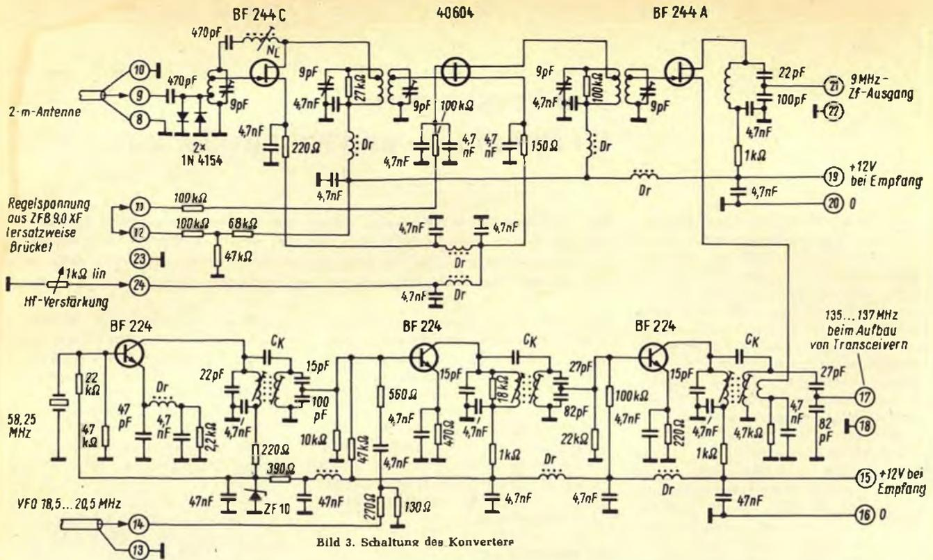
Bild 3. Schaltung des Konverters
