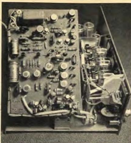
Bild 12. Ansicht der hochgeklappten Steuerplatine von oben. Ganz oben in der Mitte die IS für den Sägezahngenerator. Ganz unten die Schaltung für den Überlauf und die Polaritätsanzeige (Doppel-Filippflop). Darüber die drei in Reihe stehenden Transistoren für den RC-Oszillator. Links davon die drei IS für Impedanzwandler, Meßwert- und Nullvergleicher
