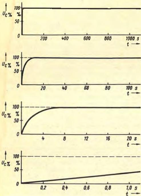
Bild 1.5. Ladekurve eines Kondensators mit verschiedenen Zeitmaßstäben dargestellt
