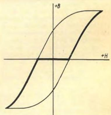
Bild 3. Die Hysteresisurve. B = magnetische Induktion im Körper, H = Feldstärke des einwirkenden Magnetfeldes
