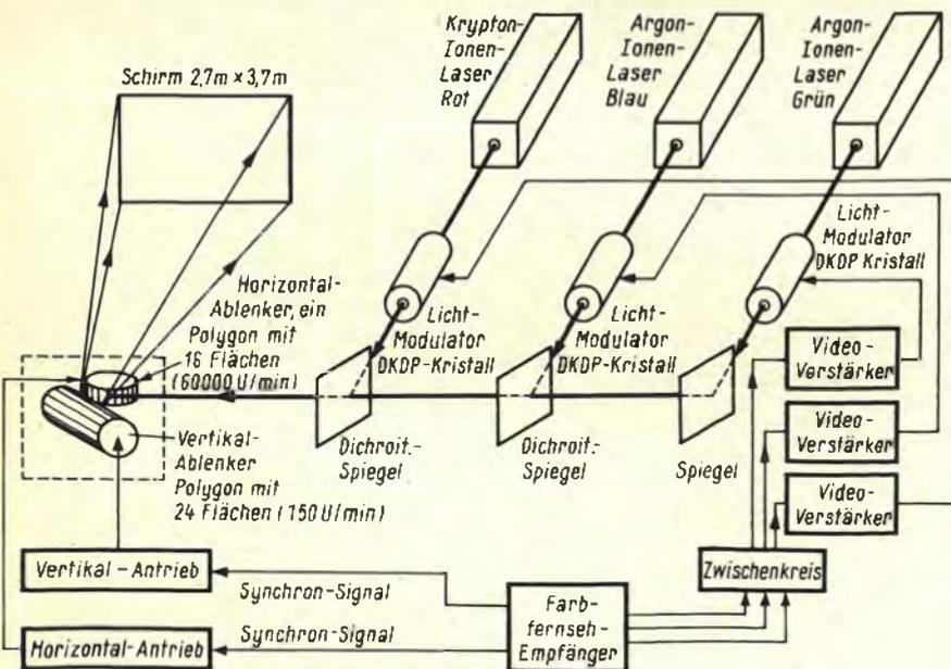
Bild 2. Schema des von Hitachi entwickelten Laser-Projektionsgerätes
