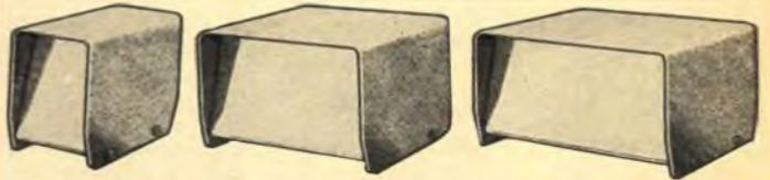
Jedes Gehäuse besteht aus 2 Teilen: Chassis mit 2 Frontplattenwinkel und Gehäusehaube. Material: Eisenblech 1 mm. Chassis feuerverzinkt. Gehäusehaube beige lackiert. Die Verbindungsschrauben werden mitgeliefert.
