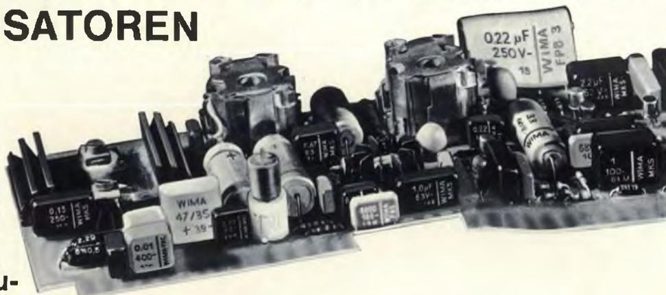
das war unsere Entwicklungsaufgabe vor einigen Jahren. Unsere Idee hat sich durchgesetzt: Steckbare Kunststoffolien-Kondensatoren mit Kleinstabmessungen für die moderne transistorisierte Leiterplatte! Wir haben eine führende Marktstellung auf dem Gebiet der metallisierten Kunststoffolien-Kondensatoren. Nur diese Kondensatorenart ermöglicht geringe Abmessungen bei größeren Kapazitäten.
