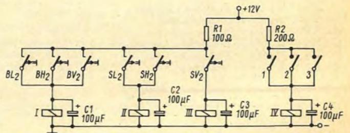
Bild 2. Blockschaltung des Empfängers
