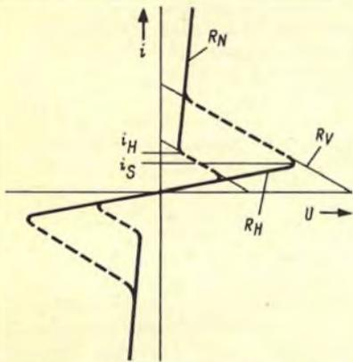
Grundsätzliche Strom-Spannungskennlinie eines Glas-Halbleiters:  $i_H$  = Haltestrom;  $i_S$  = Schwellenstrom;  $R_V$  = Vorwiderstand;  $R_H$  = hoher Widerstand;  $R_N$  = niedriger Widerstand
