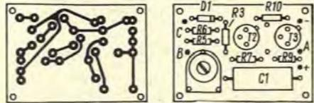
Bild 4. Druckplatte für die Schaltung von Bild 2
