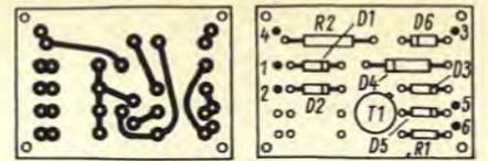
Bild 3. Druckplatte für die Schaltung von Bild 1
