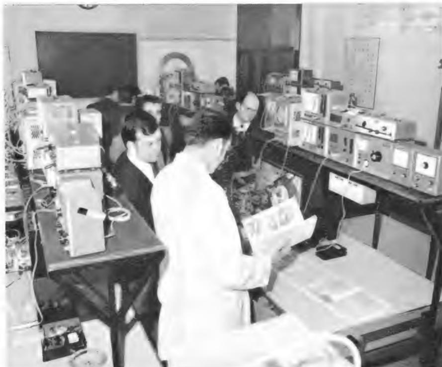
Bild 4. Teilansicht des Praxisraumes, an dessen Plätzen ein zentral eingespeistes Farbbalken- bzw. Treppensignalsignal zur Verfügung steht. Hier werden unter anderem Breitband-Oszillografen, Digital-Voltmeter, Wobbler, Universal-Voltmeter und Farbsignal-Generatoren FG 4 benutzt.
