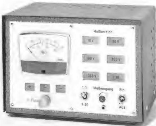
Links: Bild 1. Das selbstgebaute automatische Röhrevoltmeter
