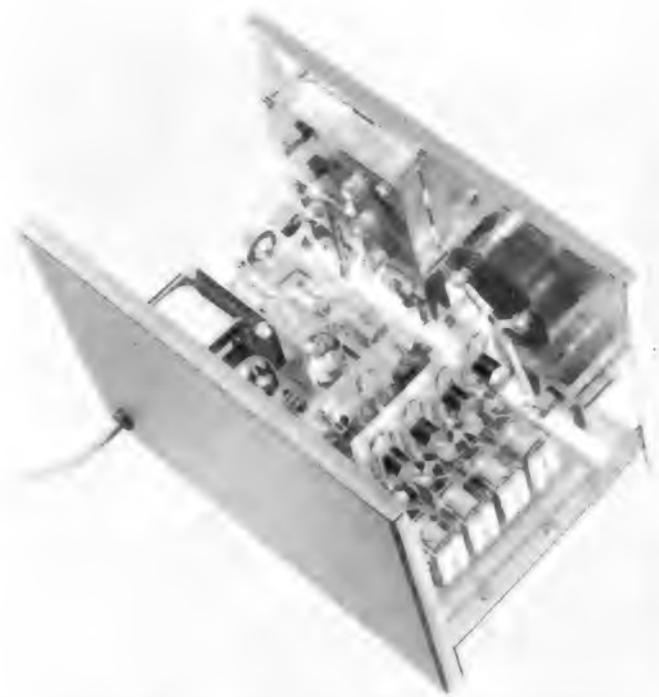
Rechts: Bild 7. Innenansicht des Röhrenvoltmeters
