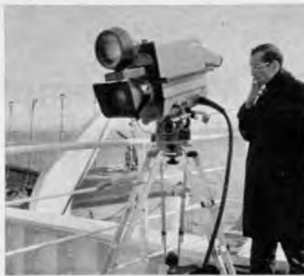
Bild 2. Die Studiokamera mit aufgesetztem Spotlight (Punktscheinwerfer) und Variooptik in Aktion auf dem Sonnendeck
