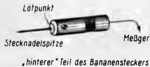
Aufbau des Nadeltastkopfes, mit dem man die gebräuchlichen Kabelisolierungen durchdringen kann
