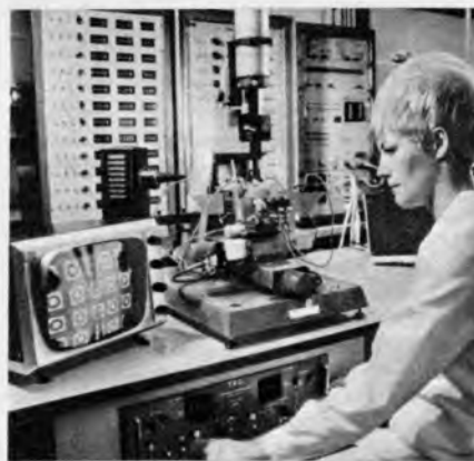
Fernseh-Mikroskop und Monitor in der Halbleiter-Fertigung
