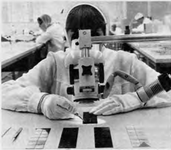
Bild 2. Prüfung eines Solarzellenmoduls in einem Super-Clean-Raum bei AEG-Telefunken unter dem Stereo-Mikroskop
