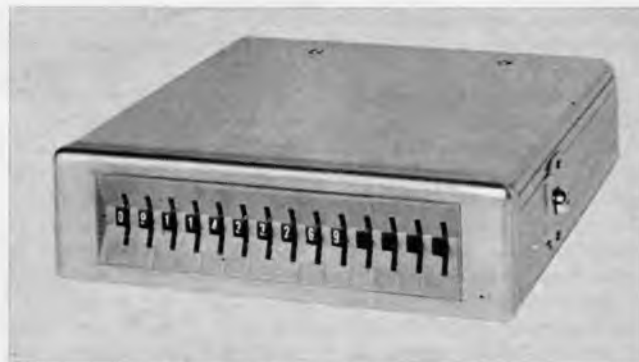
Bild 7. Versuchsmuster eines Ziffern-gebers für Fahrzeuganlagen in vollautomatisch betriebenen öbL-Netzen
