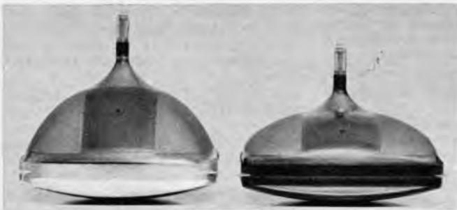
Die neue Valvo-Farbbildröhre mit 110°-Ablenkwinkel (rechts) ist neun Zentimeter kürzer als ihr Vorläufertyp mit 90°-Ablenkung (links)
