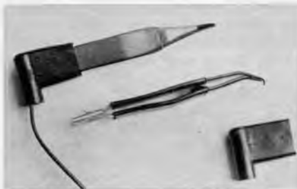
Bild 1. Nur 50 mm lang und 4 g schwer ist diese Klemmprüfpinzette Typ Mini-Clip (Werkaufnahme: W. Riess, Konstanz)
