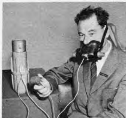
Bild 2. Sprechsystem für Taucher mit Mikrofon in der Atemmaske. Verstärker und druckfester Lautsprecher befinden sich in dem Al-Gehäuse links. Dieses Modell Subaqua P führt Projektingenieur J. C. Carter von Goodmans vor
