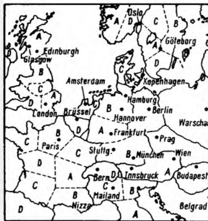
Bild 8. Karte der Funkrufgebiete des europäischen Funkrufdienstes. Unser Ausschnitt zeigt nur den zentralen Teil, vorgesehen ist die Einbeziehung von Gesamt-Scandinavien, von Griechenland, der Türkei, Spanien und Island. A = 78,340 MHz, B = 87,365 MHz, C = 87,390 MHz, D = 87,415 MHz
