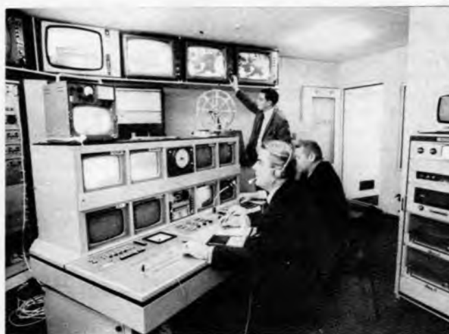
Bild 1. Fernsehregieraum an Bord der TS „Hamburg“ mit Regiepult und Fernsehempfänger für die verschiedenen Normen (oben). Rechts im Bild: Teile der Ela-Anlage mit zwei Plattenspielern und Allwellen-Rundfunkgeräten
