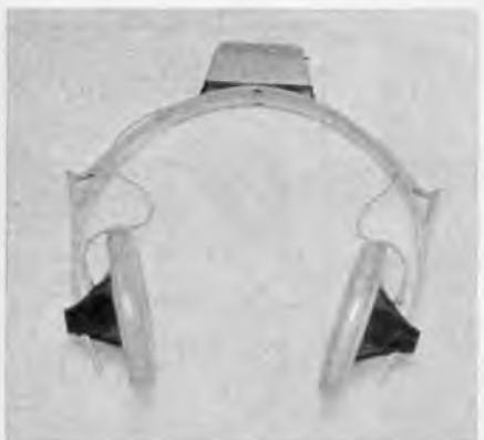
Bild 8. Leichter Kopfhörer mit Nf-Empfänger auf dem Bügel. Der Träger dieses Hörers, Modell 648 Danasonic von Danavox, Kopenhagen, kann sich innerhalb des von einer Induktionsschleife umgebenen Gebietes frei bewegen
