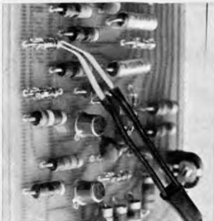
Bild 2. Der Adlerschnabel der Pinzette erfäßt auch sehr kurze Leitungsstücke und hält sicher daran fest
