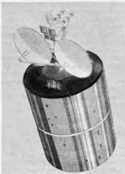
Bild 1. Intelsat IV ist 274 cm hoch und trägt zwei 4,5°-Parabolantennen, vier 17°-Hornantennen (je zwei für Senden und Empfang) sowie weitere Telemetrie- und Kommandoempfängerantennen
