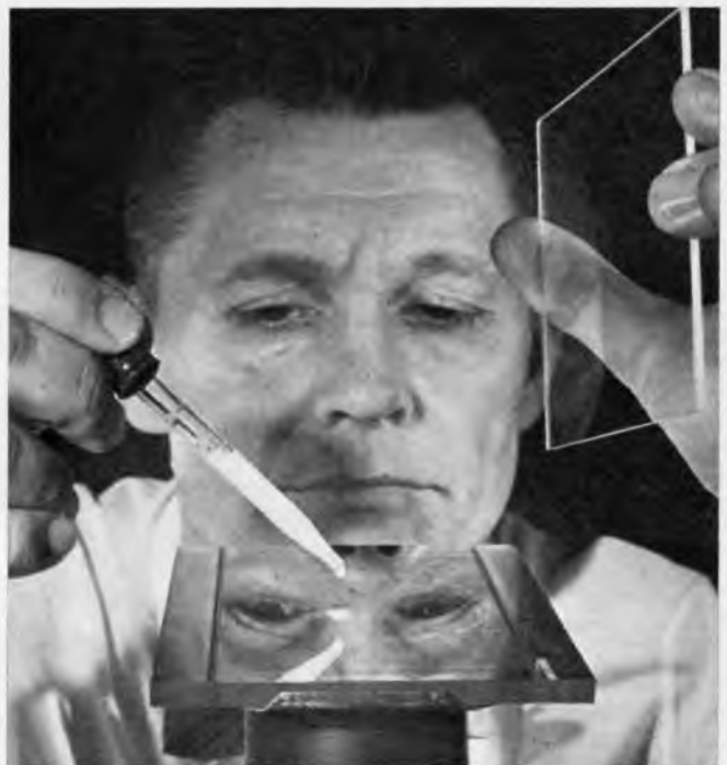
Bild 3. Nur einige Tropfen nematischer Kristalle genügen als Dielektrikum zwischen den leitenden Glasflächen des Flachbildschirms
