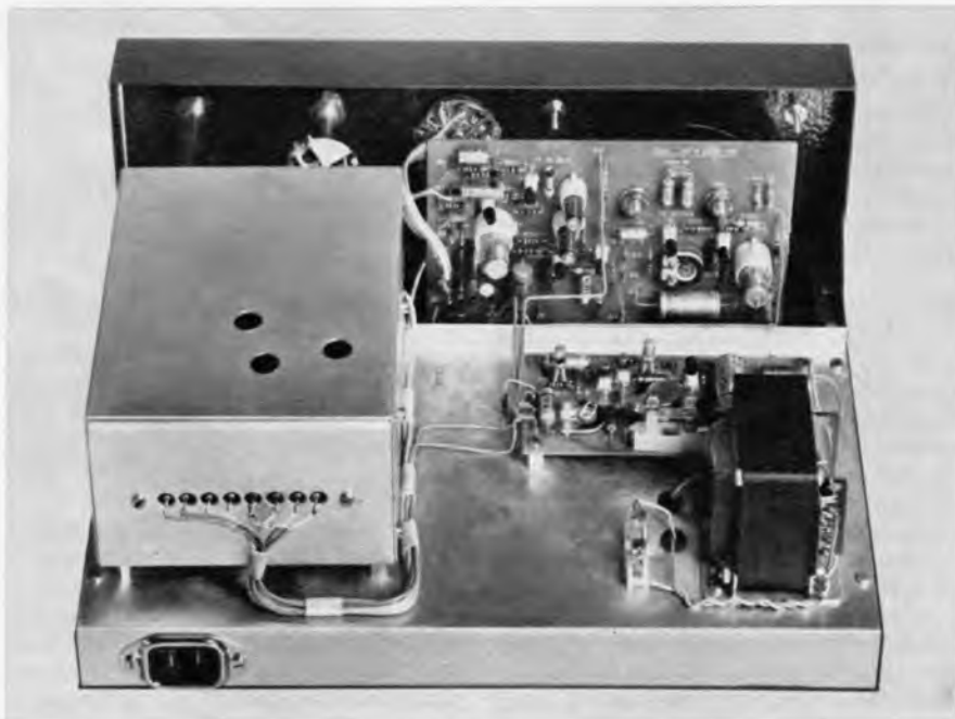
Unten: Bild 2. Blick in das Innere des Gerätes. Der Brückenteil ist eingekapselt
