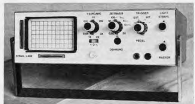
Bild 1. Außenansicht des Mustergerätes des transistorbestückten Kleinoszillografen
