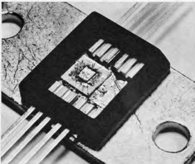
Bild 2. Großaufnahme der geöffneten flat pack
