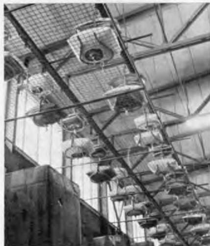
Unter der Decke einer Fabrikationshalle werden die aus dem Freien kommenden Bildröhren vorgewärmt
