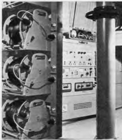
Auf kleinstem Raum, zwischen Kabeltrommeln, Regiepult und drehbarem Antennenmast sind der transistorbestückte UKW-Sender und der VHF-Ballempfänger im neuen Funk-Übertragungswagen des Bayerischen Rundfunks untergebracht
