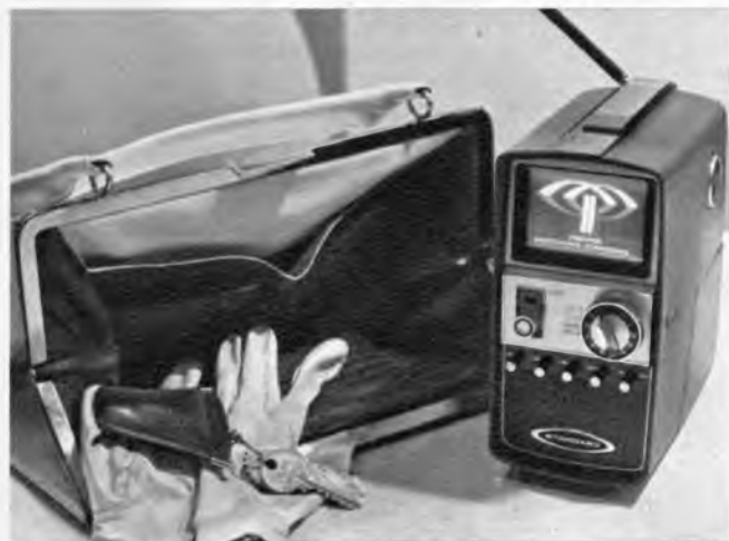
Bild 1. Dieses Mini-Fernsehgerät vom Typ TV 3 A (Standard Corporation) verfügt trotz seiner geringen Abmessungen über alle VHF- und UHF-Empfangsbereiche (Aufnahme: E. Schwahn)
