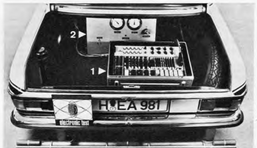
Bild 2. Der Kofferraum des Testwagens nimmt die Steuerelektronik (1) und die elektro-pneumatische Bremsvorrichtung auf. Ganz unten die Meßantennen für das Leitkabel
