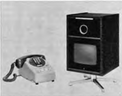
Fernseh-Telefon mit einer Bandbreite von 1 MHz und einer Auflösung von 275 Zeilen
