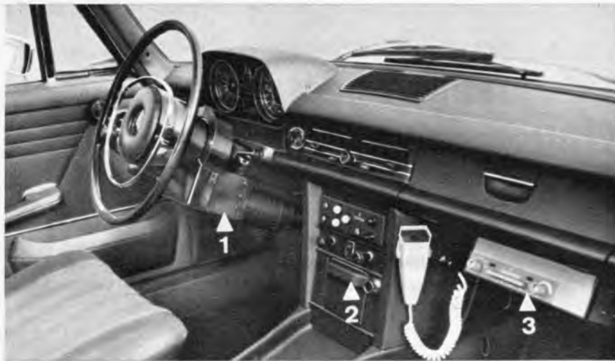
Bild 3. Blick in das Fahrzeuginnere des elektronisch gesteuerten Reifentestfahrzeugs mit der elektro-mechanischen Lenkung (1), der Kontroll- und Wählautomatik (2) und der Funkanlage für die Meßwertrückmeldung (3)
