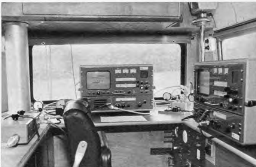
Meßaufbau für Reflexionsmessungen im Funkmeßwagen 64 mit zwei Fernseh-Meßempfänger Heuke E 51 AS, von denen der eine (rechts) zur Synchronisation des reflektierten Signals mit dem Nutzsignal dient
