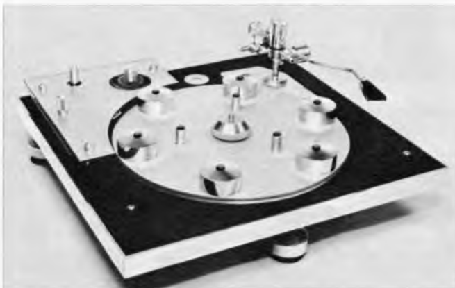
Bild 13. Transcriptor-Plattenspieler mit Tonarm vom Typ Micro-MA 77 S. Die Schallplatte ruht auf den Gummipuffern, die von den Spitzen der sechs Gewichte bzw. der drei Bolzen gebildet werden
