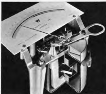
Bild 3. Schnittmodell eines dynamischen Instrumentes
