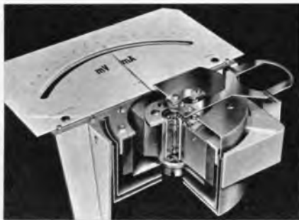
Bild 1. Schnittmodell eines Drehspul-Instrumentes
