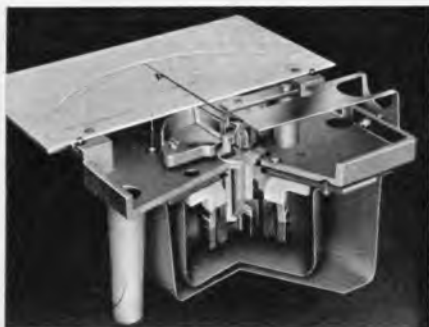
Bild 2. Schnittmodell eines Dreheisen-Instrumentes
