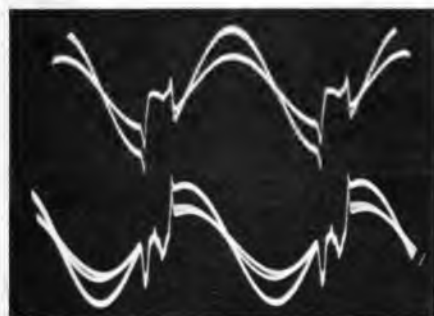
Bild 8. Oszillogramm der beiden Farbdifferenzspannungen U und V bei falschem Amplitudenverhältnis zwischen direktem und zeitverzögertem Signal
