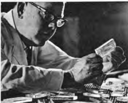
Oben: Glas für Farbfernseh-Verzögerungsleitungen auf der neuen Fertigungsstraße bei Chance-Pilkington. Das der Wanne entnommene halbflüssige Glas wird zu diesen Glasrohlingen gepreßt.
