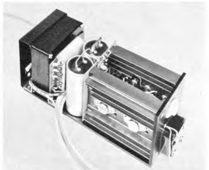
Oben: Bild 18. Schaltung des stabilisierten Netzteils
