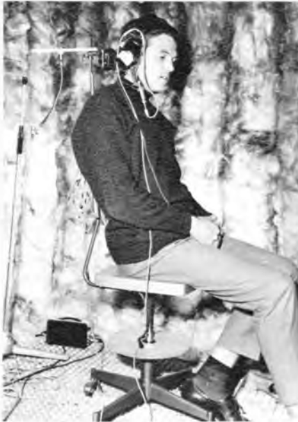
Bild 3. Meßanordnung für die Entwicklung von Kopfhörern mit Hilfe verschiedener Versuchspersonen
