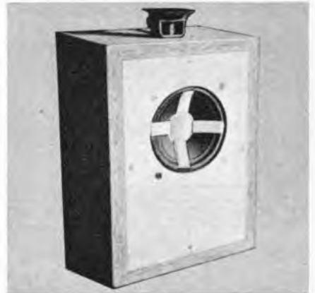
Bild 3. Laboraufbau der Box mit nach oben strahlendem Hochtoner
