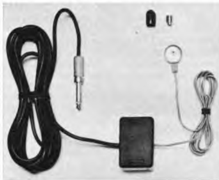
Oben: Bild 5. Tonabnehmer Pictron (Echolette) für Blasinstrumente. Oben rechts das Anschlußröhrchen, daneben eine Verschlusskappe. Darunter der Tonabnehmer mit Vorverstärker (Tonblende, Pegel-einsteller) und Anschlußkabel
