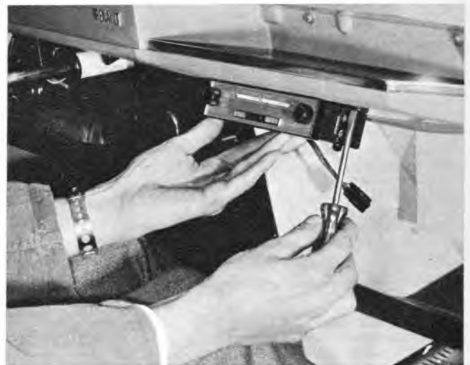
Bild 2. Der Einbau unter das Armaturenbrett ist mit einfachsten Hilfsmitteln möglich
