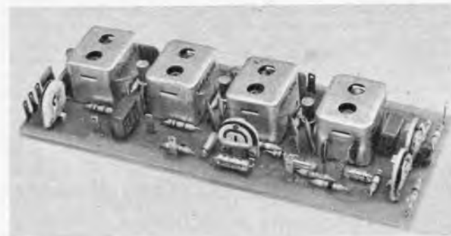
Bild 7. Die Zf-Platine enthält den vierstufigen Zf-Verstärker sowie die automatische Rausch-sperre
