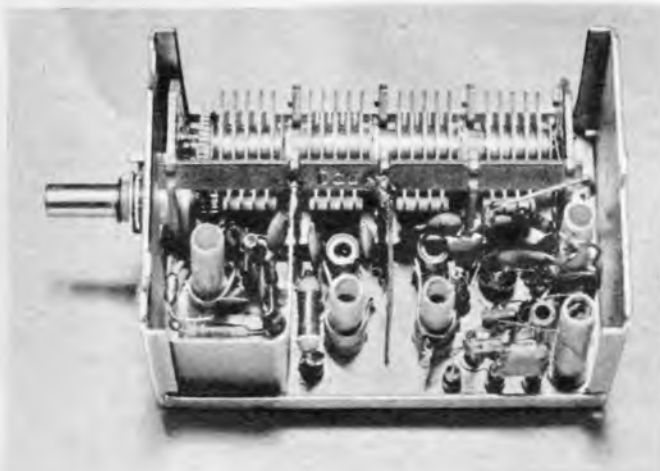
Bild 5. Der geöffnete Tuner. Links in der Kammer befinden sich die Transistoren T 1, T 2 und die Spule L 4. In der Mitte erkennt man die Spulen L 7 und L 8
