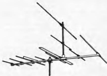
Bild 1. Fernseh-Yagi-Antenne mit Anti-Flutter-Zusatz gegen Bildflattern in der Nähe von Flughäfen
