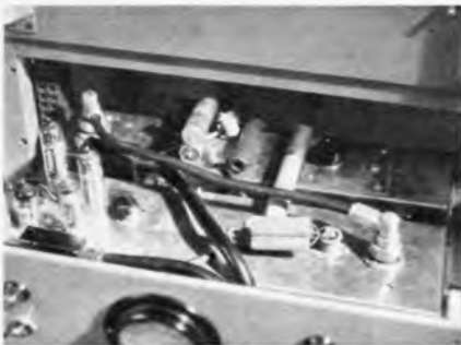
Bild 6. Blick in den quartzesteuerten Bildsender, der im 70-cm-Amateurband arbeitet
