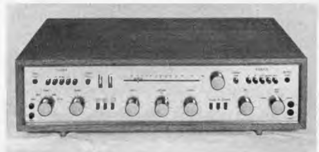
Bild 1. Vorderansicht des Steuergerätes, zwei der Tasten sind für einen geplanten elektronischen Sendersuchlauf vorgesehen
