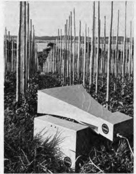
Mit Hilfe der elektronischen Vogelscheuche von Saba lassen sich Vögel von Obstplantagen, Weinbergen oder Flugplätzen fernhalten
