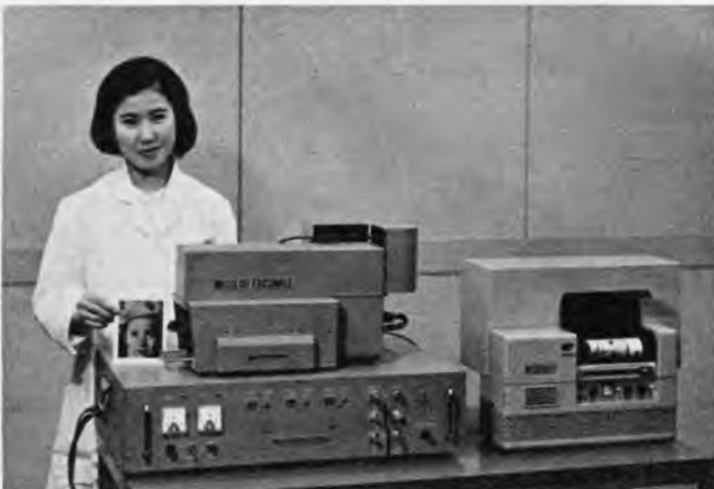
Die neue Faksimile-Übertragungseinrichtung für Farbfotos von Matsushita. Die Helligkeit der drei nach einem Spezialverfahren modulierten Xenonlampen verkürzt die Übertragungszeit. Die drei Farben werden simultan übertragen. Rechts im Bild der Geber, links die Empfangseinrichtung
