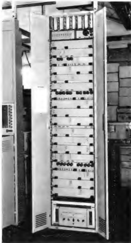
Bild 3. Endeinrichtung für die trägerfrequente Tonübertragung mit Frequenzumsetzern und Kompondern nach dem Entwicklungsstand von 1962 (Aufnahme aus dem Prüffeld)
