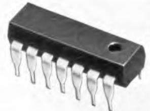
Integrierte Silizium-Plastik-Schaltkreise mit plastikvergossenem Gehäuse aus einem Stück haben gerade Anschlussdrähte zur Arbeitserleichterung für den Anwender.
