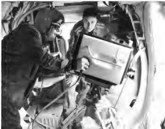
Bild 1. Eine in einem Bundeswehr-Hubschrauber vom Typ Vertol eingebaute Fernsehkamera lieferte über einen 50-W-Sender Aufnahmen von der Rennstrecke. Die Empfangsstation stand auf dem Turm der Nürburg
