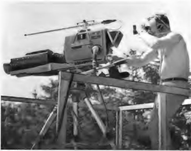
Bild 3. Eine der am Nürburgring aufgestellten Orthikon-Kameras mit Vario-Optik und einem angebauten Sennheiser-Richtmikrofon
