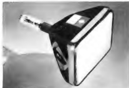
Die Telefunken-Elektronenstrahlröhre M 17-11 besitzt einen rechteckigen Schirm mit einer ausnutzbaren Fläche von 9,5 \text{ cm} \times 12,5 \text{ cm}
