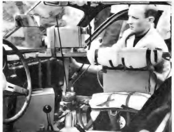
Bild 2. Beim ADAC-1000-km-Rennen hatte man versuchsweise eine Vidikon-Kamera (oben) in einem Porsche-Rennwagen GTS-904 eingebaut. Links unten der CSF-Reportagesender, ein Telefunken-Funksprechgerät daneben
