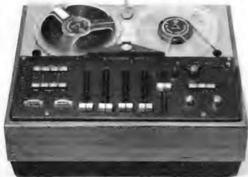
Links: Bild 1. Beocord 2000 de Luxe von Bang & Olufsen, ein vielseitiges Stereo-Tonbandgerät mit angebautem Mischpult. Das Gerät arbeitet in Zweispurtechnik, hat aber einen Vierspurnkopf für die Wiedergabe von bespielten Bändern
