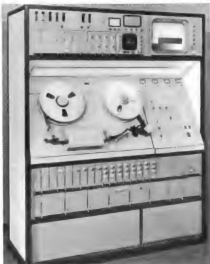
Mit der Magnetbandanlage BC M 40 A lassen sich pro Band etwa 90 Minuten Bild und Ton in Schwarzweiß oder Farbe aufzeichnen
