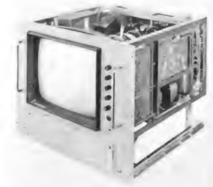
Bild 2. Der Monitor MF-01 für den Gestelleinbau. Alle Bedienelemente liegen vorn
