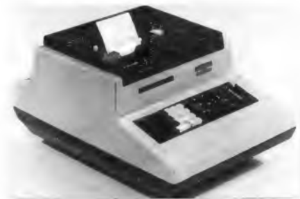
Bild 2. Elektronischer druckender Tischrechner Diehl combitron
