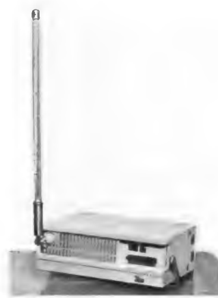
Bild 9. Melde- und Alarmempfänger mit Transistorbestückung. Dieser Doppelsuperhet ist fest auf einen Alarmsender abgestimmt (SEL)
