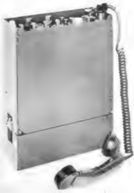
Bild 6. Tragbares UKW-Funksprechgerät FuG 7b mit Handhörer und untergesetztem Gleichstromwandler (Telefunken)
