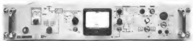
Bild 11. Stereosicherer UKW-Ballempfänger für Rundfunkanstalten (Telefunken)
