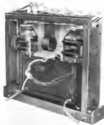
Bild 37. Der Argon-Gaslaser LG 12 von Raytheon liefert eine besonders große Ausgangsleistung
