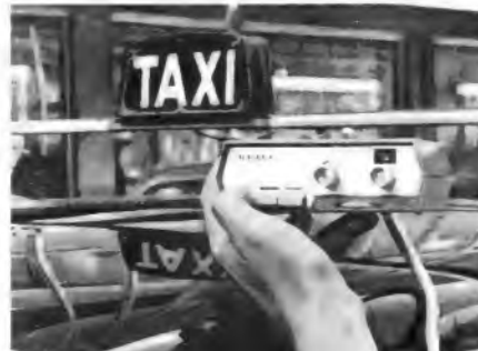
Bild 5. Bedienungsteil des neuen Taxifunkgerätes W 12 (Siemens)
