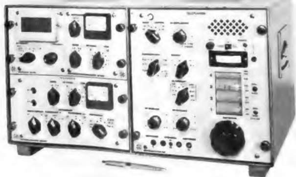
Links: Bild 10. Kurzwellen-Einseitenbandempfänger Transradio 15 (Telefunken)
