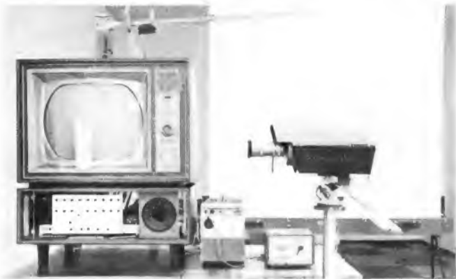
Lehrgeräte für den Farbfernseh-Lehrgang des Handels in Bayreuth. Die Kamera rechts überträgt Oszillogramme auf die Schwarzweiß-Empfänger im Saal
