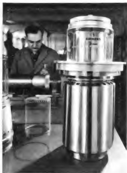
Bild 2. Sendetriode RS 2041 mit einer Anodenverlustleistung von 220 kW. Links neben der Röhre das Maschengitter und ganz links der fertige Katoden/Gitter-Aufbau (Siemens)
