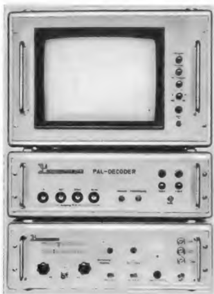
Bild 3. Der Monitor in RGB-Ausführung (d. h. eingerichtet für direktes Zuführen der drei Farbsignale ohne Codierung) mit dem neuen Pal-Decoder MF-05 und dem Hf-Steuergerät MF-02
