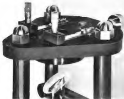
Links: Bild 34. Dieses Foto zeigt das Brewster-Fenster am Ende der Entladungsröhre und die Spiegelhalterung und Justier-einrichtung bei einem Gaslaser von Sylvania (Werkbild Sylvania)
