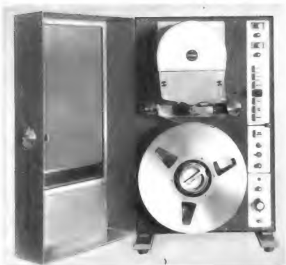
Bild 12. Kompakt aufgebauter Videorecorder mit einer oberen Grenzfrequenz von 3,5 MHz (Precision Instrument/Saba)
