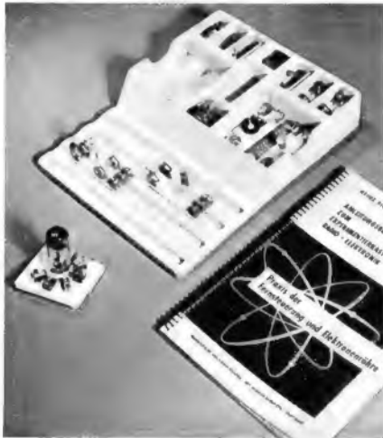
Bild 1. Der Kosmos-Experimentierkasten dient zugleich als Grundbrett für die Versuche und Aufbewahrungskasten für die Einzelteile. Das Handbuch enthält 125 Versuchsschaltungen
