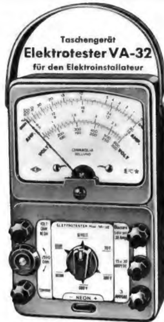
mit Schmelz-Sicherung gegen Überlastung
