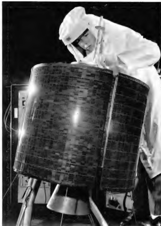
Bild 2. HS 303 auf dem Prüfstand der Hughes Aircraft Co. Die Außenfläche des zylindrischen Körpers mit 58 cm Länge und 71 cm Durchmesser ist mit 6000 Solarzellen besetzt
