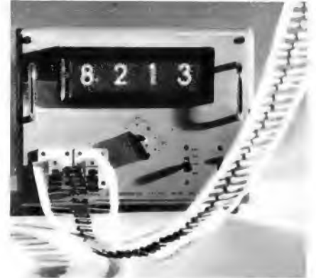
Das neue Ziffernohmometer RDZ mit digitaler Meßwertanzeige und -ausgabe wurde für rasche, genaue Widerstandsmessungen zwischen 1 m \Omega und 100 M \Omega bei dekadischer Anzeige entworfen
