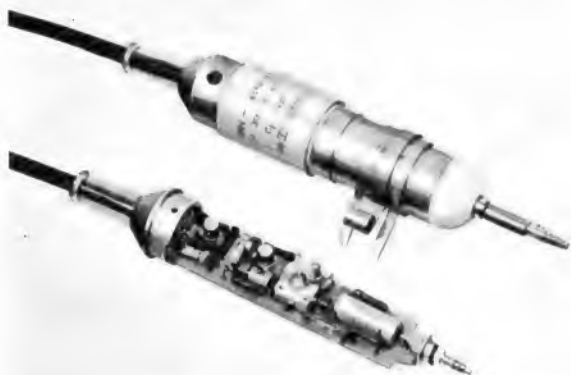
Bild 4. Konstruktive Ausführung des Transistor-Tastkopfes
