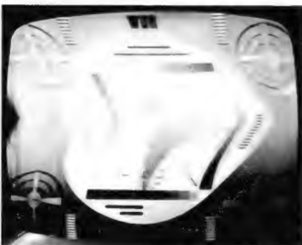
Bild 5. Brummeinstreuung in die erste Zf-Stufe
