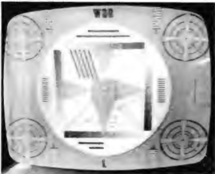
Bild 4. Regelspannungsfehler in der Bild-Zwischenfrequenz
