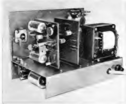
Bild 5. Rückansicht des Gerätes mit eingesteckten Platinen und Netztransformator im Hintergrund
