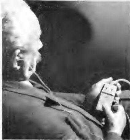
Bild 2. Eine praktische Neuerung. In die Fernbedienung ist ein Transistorverstärker für zwei Ohrhörer eingebaut; die Lautstärke läßt sich für den Empfänger und für die Hörer getrennt einstellen (Siemens)
