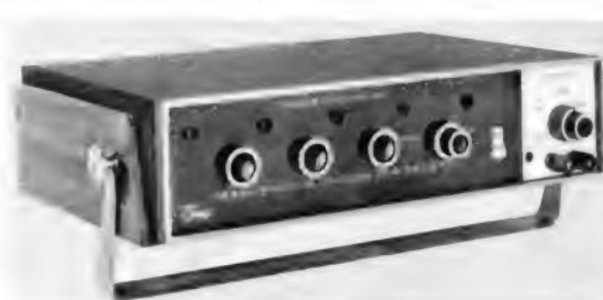
Bild 1. Frequenzgenerator mit digitaler Frequenzeinstellung der Firma Optimization Inc.
