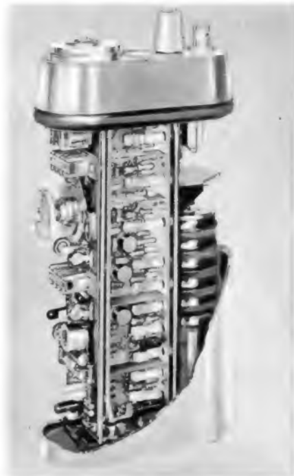
Bild 1. Senderseite des Gerätes Teleport VI, aufgeschnitten. Die Abschirmbecher sind teilweise entfernt. Links der Oszillatorbaustein
