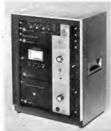
Bild 3. Meßgestell mit Frequenzgenerator, Leistungsverstärker und Ausgangsübertrager für verschiedene Impedanzen
