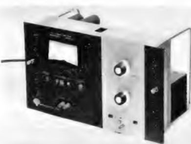
Bild 2. Zum Frequenzgenerator passender Leistungsverstärker für 250 W Ausgangsleistung als Einschub
