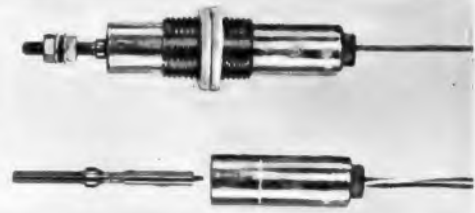
Bild 52. Philips-Meßwertaufnehmer PR 9314/01.../20. Sie arbeiten nach dem System der induktiven Differentialdrosseln. Links im Bild befindet sich jeweils der Taststift, rechts führen die Zuleitungsdrähte heraus
