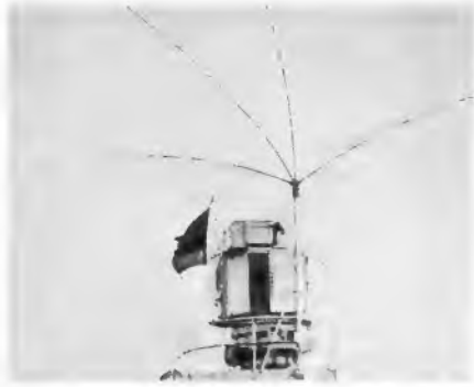
Kurz- und Grenzwellenempfangsantenne für die Aufnahme von horizontalen und vertikalen Feldstärkekomponenten aus allen azimutalen Richtungen für Polarisations-Diversity-Empfang
