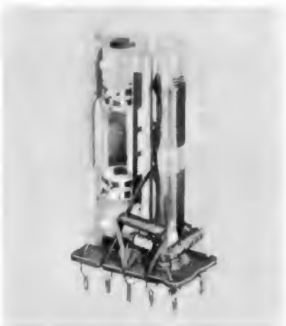
Bild 6. AM-FM-Zf-Filter mit eingebauter Begrenzerdiode
