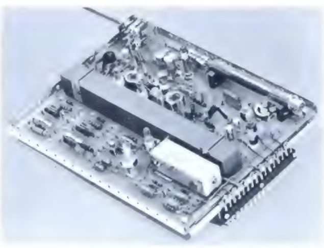
Bild 23. Adapter zum Umrüsten eines NTSC-Empfängers auf PAL-Empfang
