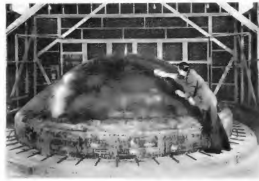
Herstellen einer riesigen Form zum Anfertigen von Antennen-Parabolspiegeln
