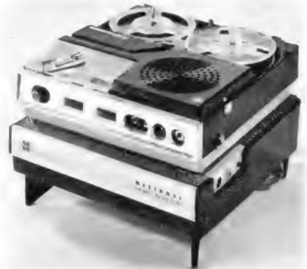
Bild 2. Der „Heim-Adapter“ mit Netzteil und Zusatzlautsprecher
