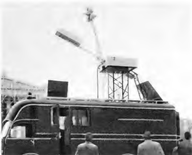
Bild 1. Die mobile Verkehrs-Fernsehanlage im Augenblick des Aufrichtens der Maste mit Fernsehkamera und Richtantenne
