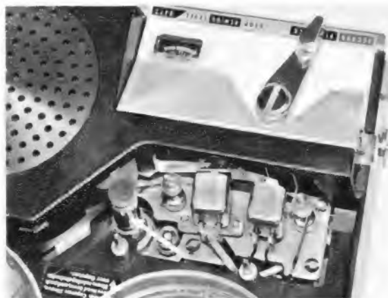
Bild 1. Die Kopfträgerplatte des RQ 115 mit der Tonwelle (Pfeil)
