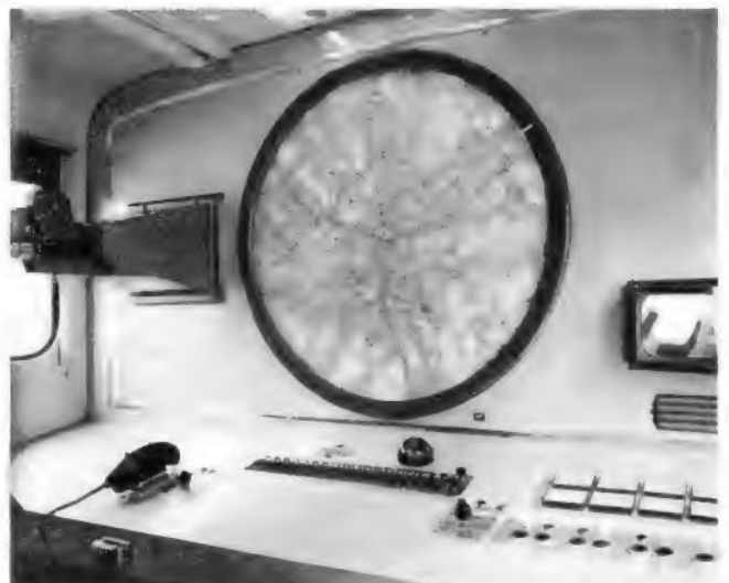
Bild 2. Das Bedienungspult im Fahrzeug. Alle Aufbauvorgänge und die Bedienung lassen sich von hier steuern
