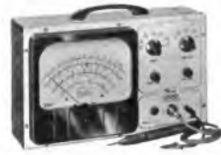
Röhrenvoltmeter de Luxe 249 DM 239.— preisgesenkt mit umschaltbarem Tastkopf US-Pat.
