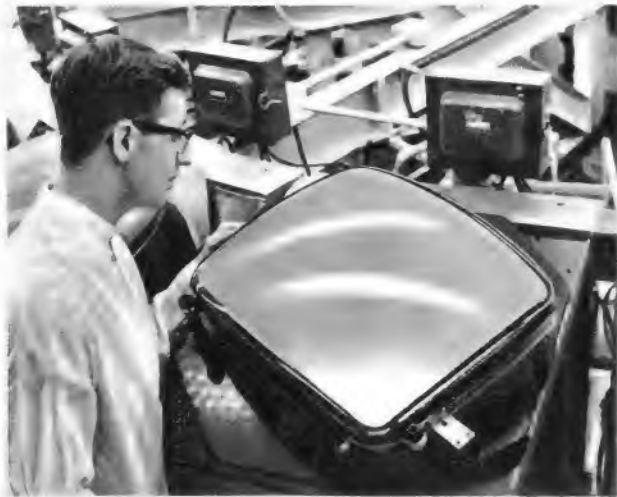
Die neue Rechteck-Farbbildröhre von The Rauland Corp. (Zenith) mit 90°-Ablenkung und einer Bildfelddiagonale von 61 cm
