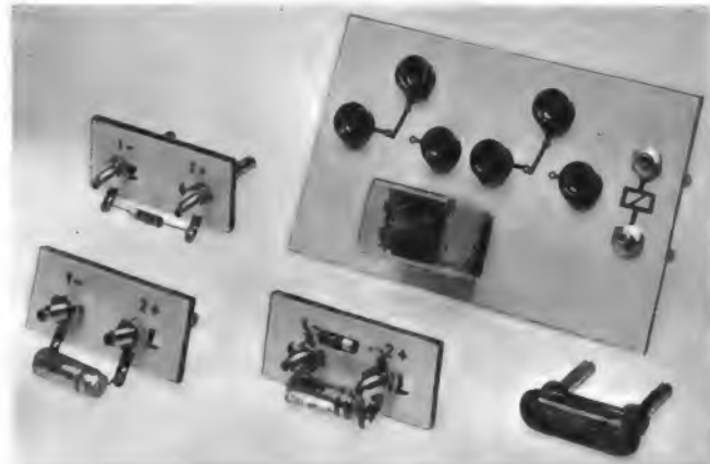
Bild 2. Die Bauelemente sind auf Kunststoffplättchen mit Steckern montiert
