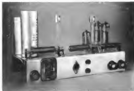
Bild 9. Blick auf das Chassis. An der Rückseite von links nach rechts: Sicherungselement, Kaltgerätestecker, Diodenbuchse des Mikrofoneinganges, Gitarreneingang, Anzeigelampen. Auf dem Chassis vorn die 15-W-Drahtwiderstände des Heizkreises
