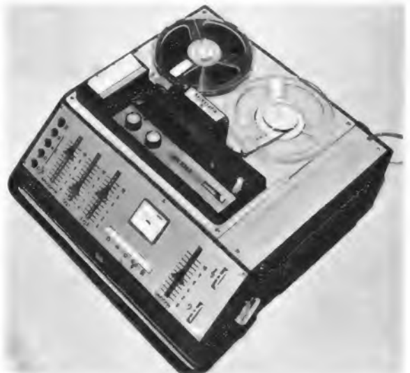
Bild 1. Das Tonbandgerät MK 3335 mit drei Antriebsmotoren und eingebautem Mischpult
