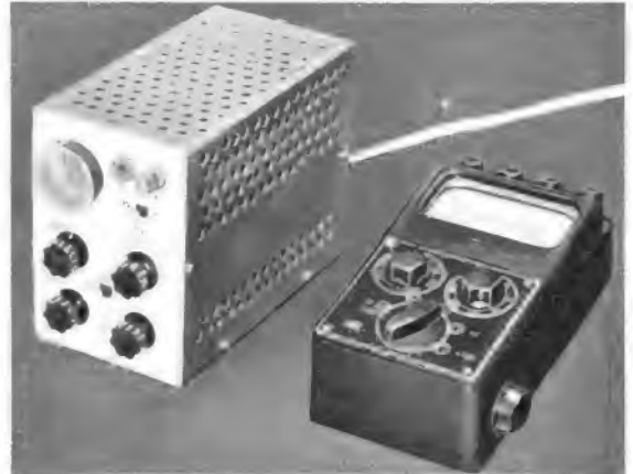
Bild 1. Der Klein-Oszillograf im Größenverhältnis zu einem Vielfach-Meßinstrument
