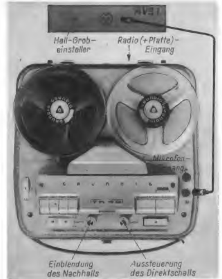
Bild 2. Nachhall-Einblendung am Tonbandkoffer TK 40 mit Hilfe der Raumhallrichtung HVS 1
