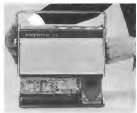
Bild 4. Das „Stülpgehäuse“ des Telefunken-Bajazzo TS erleichtert den Service
