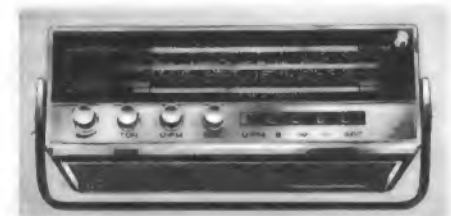
Bild 5. Der Universal-Empfänger Transita-automatic mit automatischer Scharfabstimmung (Nordmende)
