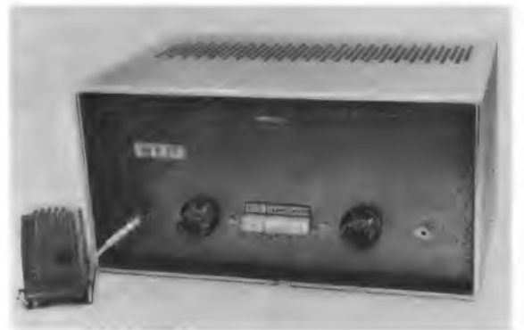
Bild 1. Der Sprach- und Modulationsverstärker MV 17. Die Frontplatte ist von links nach rechts wie folgt gegliedert: Mikrofonbuchse, Clippgrad-einsteller, Drucktastenaggregat (darüber Abstimmanzeigerröhre), Lautstärkeinsteller, Meßbuchse
