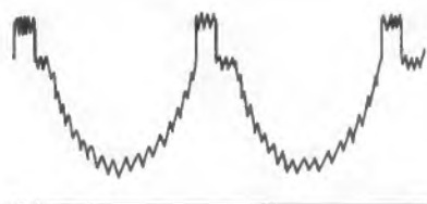
Bild 6. Video-Spannung mit überlagertem Rauschen
