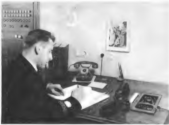
Bild 3. Der Arbeitsplatz des Kommandanten enthält rechts das Bedienungspult des auch bisher verwendeten Funksprechgerätes. Links im Hintergrund der neue Steuer-schrank mit den Selektivruf-Generatoren
