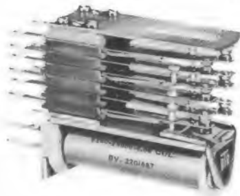
Relais 210 ähnlich mittleres Rundrelais jedoch für Starkstrom mit Makrolan- zwischenlagen
