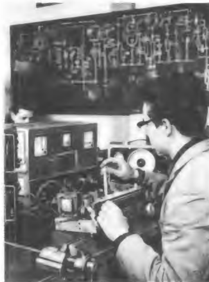
Bild 2. Ein Lehrling beim Abgleichen eines Rundfunkempfängers. Das Schaltbild an der Tafel vermittelt die Grundlagen dazu
