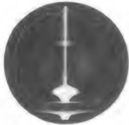
Bild 5. Sichtenzeige, Fisch über Grund, Wassertiefe = 14 m, Nullschallanzeige bei etwa 14 m
