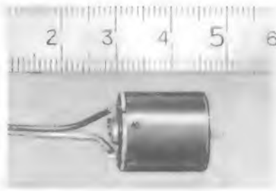
Bild 3. Ansicht eines Zwergmotors Typ T 05 mit Glockenanker und Zweischicht-Wellenwicklung. Die Leistung beträgt 0,5 W, der Wirkungsgrad 60 % (Dr. Faulhaber)
