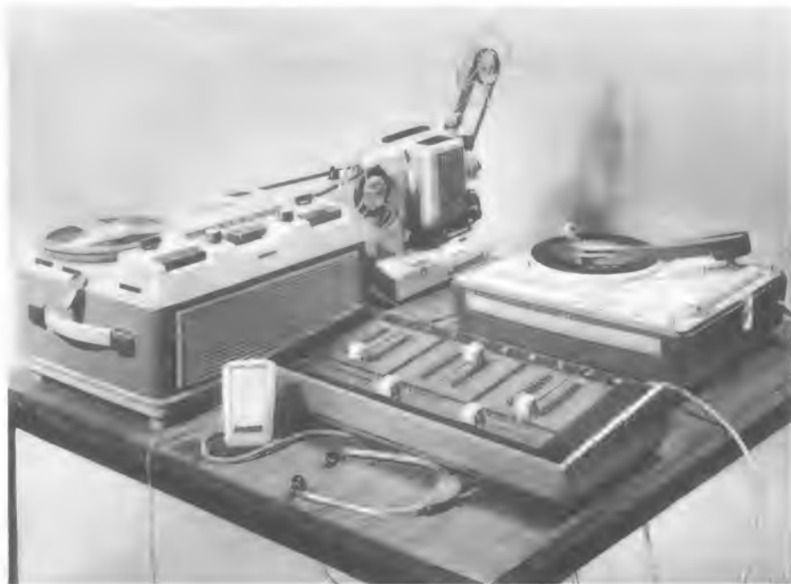
Bild 1. Arbeitsplatz zum Vertonen von Schmalfilmen. Der Noris-Synchroner TS und das Noris-Tonbandgerät sind nur über eine Tonbandschleife verbunden
