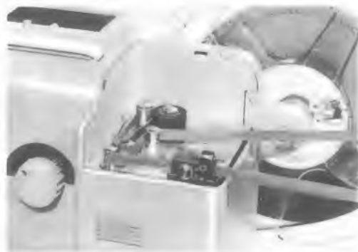
Bild 1. Arbeitsplatz zum Vertonen von Schmalfilmen. Der Noris-Synchroner TS und das Noris-Tonbandgerät sind nur über eine Tonbandschleife verbunden
