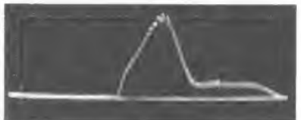
Bild 12. Mit Tastimpulsen überlagerte Durchlaß- kurve. Die Ursache ist ein schadhafter Siebkon- densator in der getasteten Regelung
