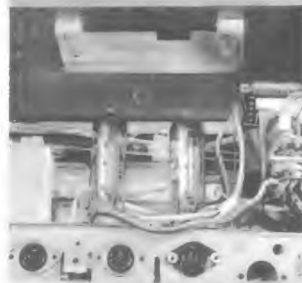
Bild 3. Wärmeableitblech zum Verhindern von unzulässig hoher Temperatur im Gehäuseinneren
