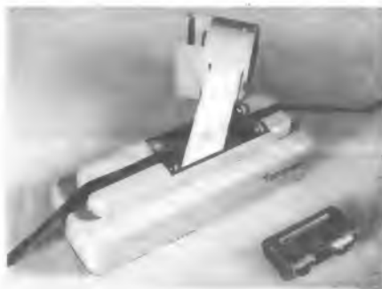
Neuartige Klebelehre der BASF, die saubere und exakte Klebestellen an Tonbändern ermöglicht. Das breite Klebeband wird schräg über die Schnittstelle gelegt und nur am hinteren Schneidblech (im Bild das vordere) angedrückt. Der Schneidwagen wird mit seinen Rollen in die Nut gesetzt und trennt beim Durchrollen zwischen den Schneidblechen das Klebeband sauber ab
