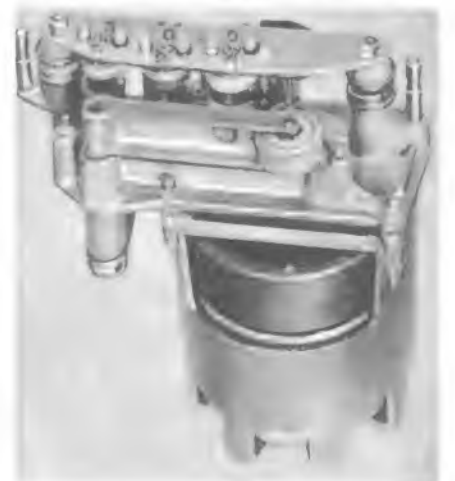
Bild 4. Antrieb des Tonbandgerätes Revox G 36; Motor, Andruckvorrichtung, Tonköpfe und Bandführungselemente sind auf einem gemeinsamen Gußblock montiert
