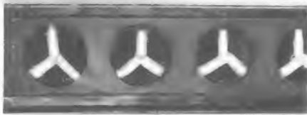
Bild 5. MH-Lautsprecheranordnung mit Schaumgummistegen auf den Membranen der Systeme
