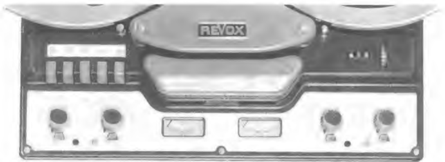
Bild 2. Anordnung der beiden VU-Meter für die Stereo-Aussteuerung
