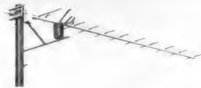
Bild 6. Mehrbereichsantenne für die Kanäle 21 bis 60 in den Bereichen IV und V. Der Dipol weist eine ungewöhnliche Schleifenform auf (Siemens)
