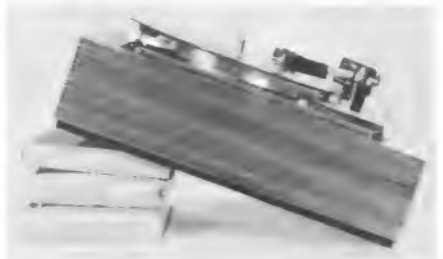
Bild 4. Plattenspieler mit statisch ausbalanciertem Tonarm arbeiten auch in Schräglage einwandfrei
