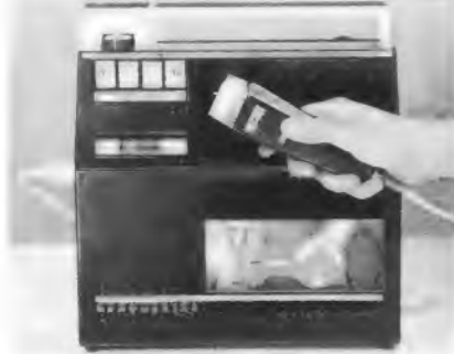
Bild 4. Tragbares Batterie-Tonbandgerät Magnetophon 300. Für den normalen Betrieb sind der Pegeleinsteller und die Schnellstoptaste im Tragegriff vorge-sehen. Bei dem im Bild dargestellten Mikrofon ist außerdem ein Aussteuerungs-instrument und ein Pegeleinsteller im Griff enthalten
