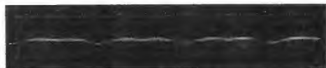
Bild 4. Lichtsnittaufnahme des Rillenprofils der V-Röhre in der Bildschirmitte. Rillentiefe 12\ \mu\text{m} = 0,012\ \text{mm} ; Rillenabstand 146\ \mu\text{m} = 0,146\ \text{mm}
