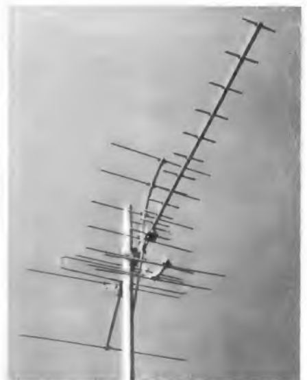
Bild 4. FSA 1 U 24. Aus zwei Empfangssystemen zusammengesetzte Mehrbereichsantenne für die Kanäle 5 - 12 und 21 - 60
