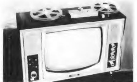
Bild 2. Telcan, eingebaut in ein 405/625-Zeilen-Fernsehgerät
