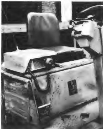
Bild 2. Beispiel für rauhen Betrieb: das Mobilphon ist erschütterungssicher auf einem Gabelstapler montiert
