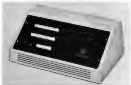
Bild 3. Das Bedienungspult der Induktivrufanlage mit den Tasten für die Nummernwahl
