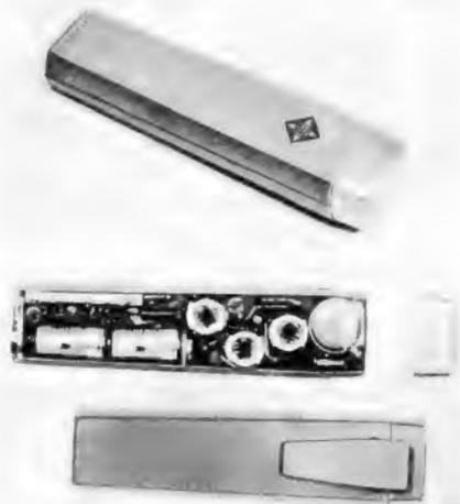
Bild 2. Der Induktivrufempfanger wiegt nur 100 g, seine Trockenbatterie erreicht eine Betriebszeit von 1 500 Stunden
