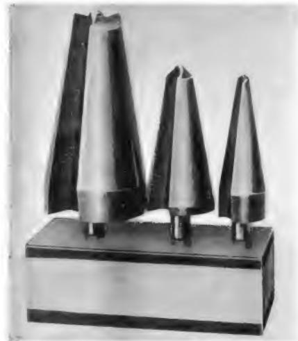
Der Schäl-Aufreiber wird in drei Größen geliefert, mit denen man Löcher bis zu 14 mm, 20 mm bzw. 30 mm herstellen kann. Beim Bohren sollte unbedingt ein geeignetes Kühl- und Gleitmittel verwendet werden
