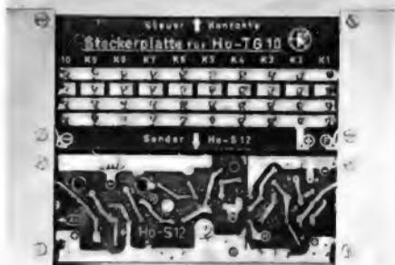
Bild 10. Sender Ho-S 12 mit Steckerplatte für die Tongeneratoren, Blick auf die gedruckten Leitungszüge (Teilansicht)
