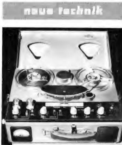
Bild 2. Tragbares Tonbandgerät hoher Gleichlaufgenauigkeit für Reporter
