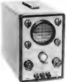
Klein-Oszillograph mit 7,5 cm Planschirmröhre, Rücklaufaustastung, Helligkeitsmodulationsanschluß (2 MOhm/25 pF), Astigmatismusträger, Mu-geschirmter Holz, 1500 V Beschleunigungsspannung, stabilisiertes Netzteil, Direktanschlußmöglichkeit der Vertikalplatten, besonders kleine Ausführung, Größe: 21,6x14,6x28,6 cm, Gewicht: ca. 5 kg
