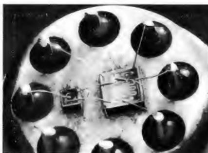
Bild 2. Microlin-Linearverstärker, bestehend aus zwei Siliziumplättchen mit je einem Transistor und sechs Widerständen, eingebaut in eine TO-5-Kapsel mit 9 mm Durchmesser (Ferranti)
