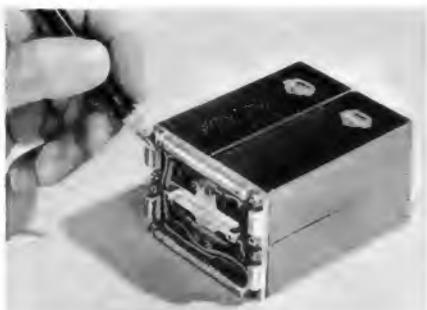
Bild 1. Integrator für eine Raketensteuerung mit 3 438 Bauelementen, darunter 1 200 Transistoren und Dioden (Mullard)
