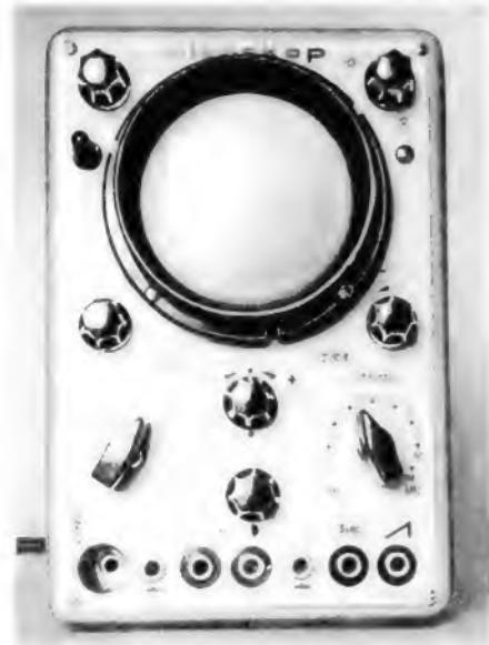
Links: Bild 2. Ansicht der Frontplatte. Die Bedienungsorgane sind symmetrisch angeordnet. Der Lichtschutztubus kann in einer Führung um etwa drei Zentimeter herausgezogen werden
