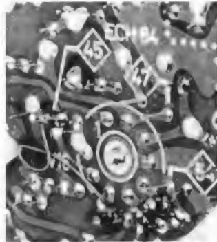
Bild 4. Bezeichnungen und sonstige Hilfsmittel für den Service auf Druckplatinen von Blaupunkt-Fernsehempfängern
