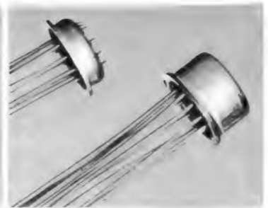
Bild 4b. TO-5-Gehäuse für einen Valvo-Festkörper-Schaltkreis mit zehn Anschlüssen; links der Sockel mit den Elektroden, rechts das geschlossene Gehäuse
