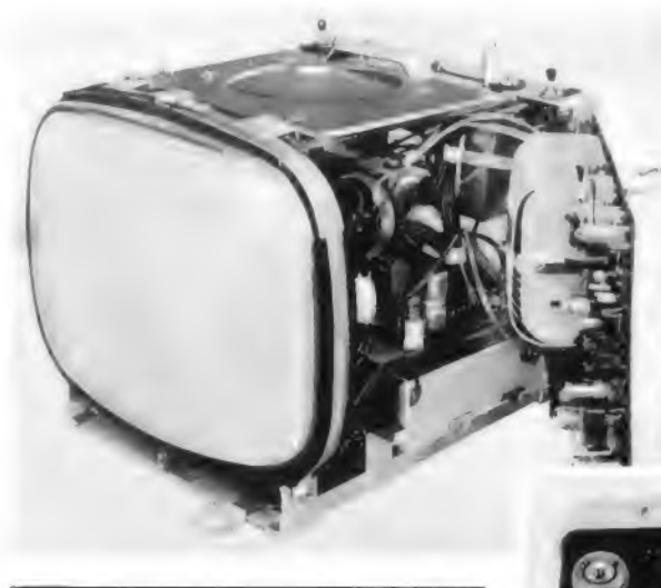
Links: Bild 1. Transistor-Fernsehgerät Transvisa (Nordmende) mit 25-cm-Bildröhre. Man erkennt die herausklappbaren, durch Stecker verbundenen Chassisteile
