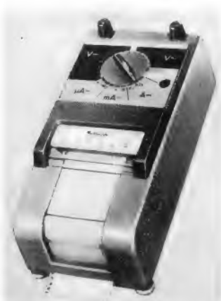
Bild 1. Vielfachinstrument Multiscript 3 mit eingebautem Schreiber (Metrawatt)
