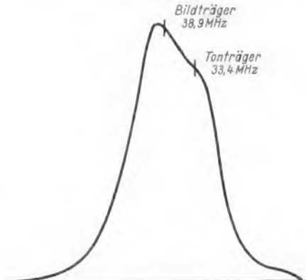
Bild 10. Verformte Durchlaßkurve bei Ankopplung des Tastkopfes über einen Kondensator von 1 nF
