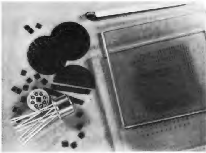
Bild 4a. Montierter und kontaktierter Festkörper-Schaltkreis auf dem Sockel eines TO-5-Gehäuses (Valvo)
