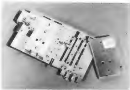
Bild 6. Verstärkereinsatz für einen Kanal im UHF-Bereich. Die hier abgenommene Abschirmkappe schützt außerdem gegen mechanische Beschädigung der Abstimmeelemente (Siemens)
