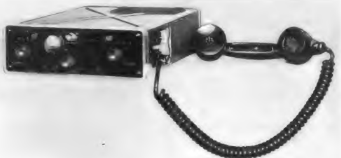
Bild 1. Teleport VI (rechts Batterie, links Nf-Zusatz mit 0,5-W-Verstärker und Mikrofon/Lautsprecher)
