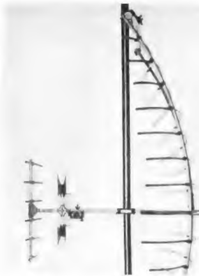
Bild 1. Parabol-Fernsehantenne mit hohem Gewinn für alle Kanäle der Bereiche IV und V (Dipola). Die untere Hälfte (die wir wegen des knappen Raumes nicht zeigen) sieht genau wie die obere aus
