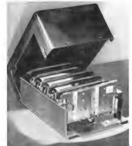
Bild 5. Gehäuse mit fünf Transistor-Verstärkereinsätzen und einem Netzeinsatz. Vorn der UHF-Verstärkereinsatz von Bild 6 (Siemens)
