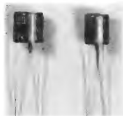
Links: Bild 4. Kleinst-Elektrolytkondensatoren für Taschenempfänger. Die maximale Höhe beträgt 11 mm (Roederstein & Türk KG)
