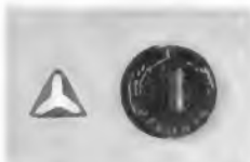
Links: Bild 4. Kleinst-Elektrolytkondensatoren für Taschenempfänger. Die maximale Höhe beträgt 11 mm (Roederstein & Türk KG)
