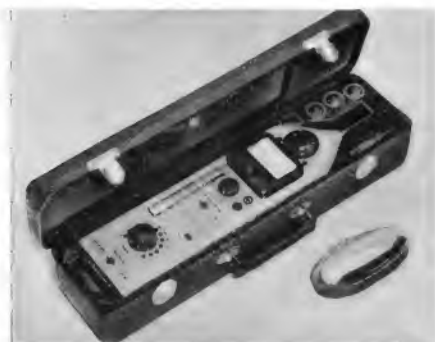
Bild 17. Tragbarer Schallpegelmessgerät Typ 2203 mit unten angestecktem Oktavfilter (Brüel & Kjaer)
