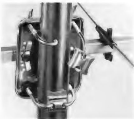
Bild 8. Die Mastschelle ist unterteilt; die beiden Hälften werden bei der Montage in das Verbindungsstück eingehakt, so daß die Flügelmutter nicht mehr ganz abgeschraubt werden müssen (Zehnder)
