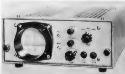
Bild 6. Panoramagerät PaG 148 für einen Frequenzbereich von 2 MHz (Telefunken)
