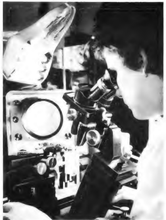
Rechts: Bild 1. Sämtliche Herstellungsvorgänge an Planartransistoren werden mit feinfühligem Justiereinrichtungen und Stereomikroskopen durchgeführt (Siemens)
