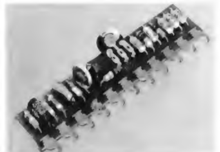
Bild 7. Einschraubbares Teilchassis („Modul“) eines Fernsehgerätes von Hede Nielsens Fabrikker A/S (Dänemark)
