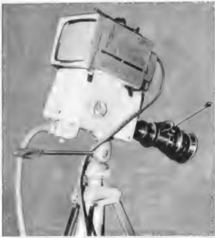
Bild 3. Transistor-Fernsehkamera mit Varlo-Optik und aufgesetztem japanischen Kleinfernsehgerät als elektronischer Sucher (Kamera: Fernseh GmbH), zusammengestellt von Loewe-Opta für den Videoaufzeichnungs-Vorführwagen
