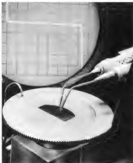
Bild 2. Vergrößerter Ausschnitt einer Meßanordnung für Planartransistoren; die Kennlinie ist auf dem Schirm sichtbar (Siemens)
