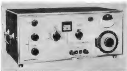
Bild 7. Universal-Meßbrücke TF 2701 von Marconi Instruments; in einem Fenster erscheinen eindeutig der Meßbereich und das Meßsymbol
