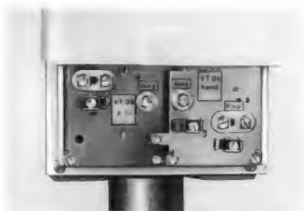
Bild 7. Zwei Transistor-Antennenverstärker für je einen Kanal im Bereich III und IV in einem gemeinsamen Gehäuse zur Montage am Standrohr (Teilansicht; Wisi)
