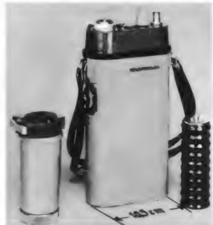
Bild 1. Teleport VI (rechts Batterie, links Nf-Zusatz mit 0,5-W-Verstärker und Mikrofon/Lautsprecher)
