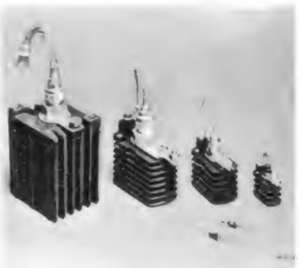
Bild 21. BBC-Silizium-Gleichrichterzellen mit Kühlkörpern
