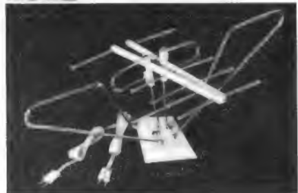
Bild 9. Kombinations-Zimmerantenne für die VHF- und UHF-Bereiche. Beide Einzelantennen werden über getrennte Zuleitungen mit dem Empfänger verbunden (Zehnder)
