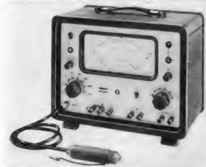
Bild 1. Vielfachinstrument Multiscript 3 mit eingebautem Schreiber (Metrawatt)
