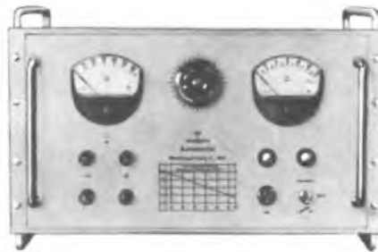
Modell 3: 5 V, 12 A bis 66 V, 5,4 A Modell 3B: 3 V, 28 A bis 36 V, 16 A
