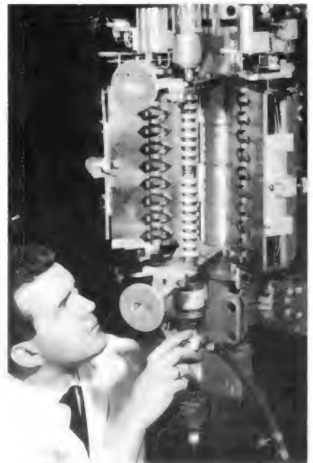
Bild 2. Siemens-Hochleistungs-Wanderfeldröhre YH 1040 mit aufgeklapptem Magnetsystem; die Röhre ist für interkontinentale Nachrichtenverbindungen über künstliche Satelliten bestimmt
