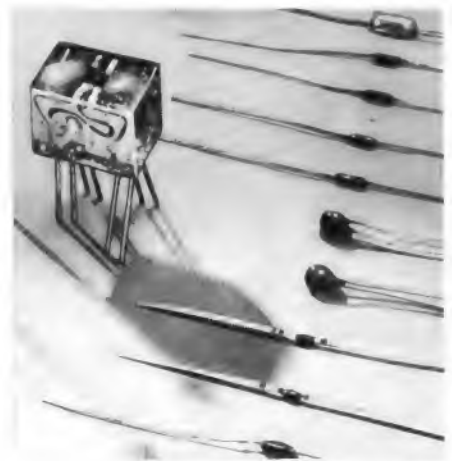
Bild 8. Elektronische Baugruppe in Siemens-Mikroblock-Bauweise. Auf kleinstem Raum ( 10\text{ mm} \times 8\text{ mm} \times 6,3\text{ mm} ) bilden fünfzehn konventionelle Kleinbauelemente, wie sie rechts liegen, einen bistabilen Multivibrator
