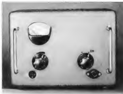
Bild 4. Das Gehäuse hat die Abmessungen 210 mm \times 148 mm \times 110 mm ohne Drehknöpfe. Das Gerät wiegt nur knapp 3 kg
