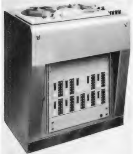
Bild 1. Frontansicht der Vierspur-Studiomaschine von Vollmer. Hinter den vier Feldern an der Vorderwand befinden sich von oben nach unten: Relaischiene, Aufsprecherverstärker und Oszillator, Wiedergabeverstärker, Mischverstärker
