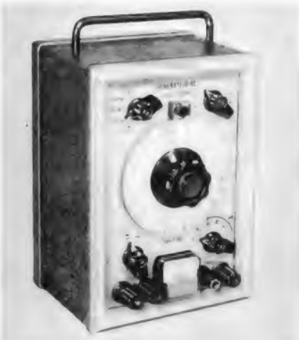
Bild 6. Volltransistorisierter RC-Generator von 1 \text{ Hz} bis 1 \text{ MHz} ohne Umschaltung; Genauigkeit \pm 3\% (Otecna)
