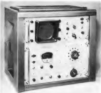
Bild 7. Vollständiger Abgleichplatz für die Industrie mit Markengeber, Wobbler und Oszillograf, eine Metrix-Neuheit
