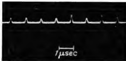
Bild 2. Verlauf der Impulsmodulation bei einem Rubin-Maser
