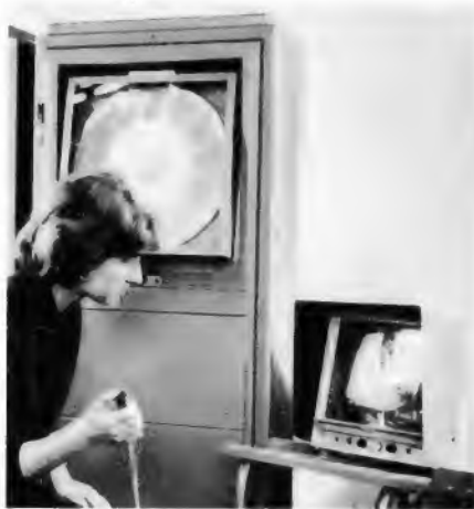
Bild 5. Beim Betätigen eines Druckschalters werden die Bildsignale eines von der Fernsehkamera aufgenommenen laufenden Vorganges auf der rotierenden Speicherfolie, links im Drehrahmegerät, magnetisch aufgezeichnet und auf dem Sichtgerät als stehendes Bild wiedergegeben; die Folie ist hier zum Sichtbarmachen hochgeschwenkt, im Betrieb liegt sie waagrecht, vgl. Bild 6
