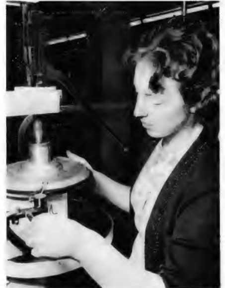
Bild 5. Der Preßrand wird abgeschliffen
