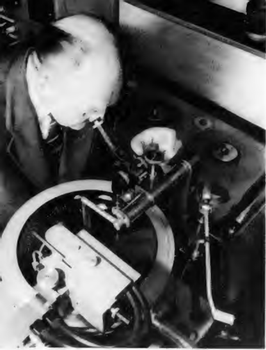
Bild 1. Das Schneiden der Lackfolie
