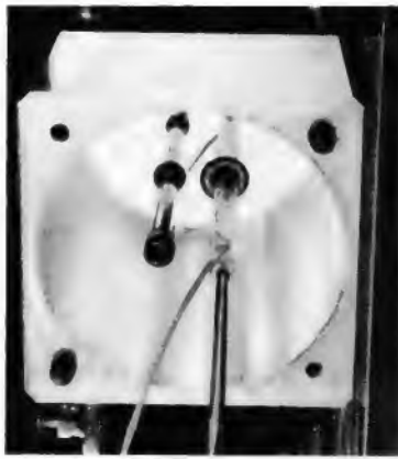
Bild 1. Versuchsanordnung (geöffnet) für einen Rubin-Maser: rechts ist eine Elektronenblitzröhre zu sehen, deren Energie in dem Rubinstab (links) konzentriert wird und dort die gerichteten Lichtblitze erzeugt; die beiden Bauelemente sitzen in den Brennpunkten des elliptischen innen hochglanzpolierten Rohres, dadurch wird die Lichtenergie von der Blitzröhre vollständig konzentriert auf den Rubin übertragen; das weiße Licht des Elektronenblitzes wird in einen intensiv roten Lichtstrahl umgewandelt, der auf der schwächer versilberten Stirnfläche des Rubins austritt
