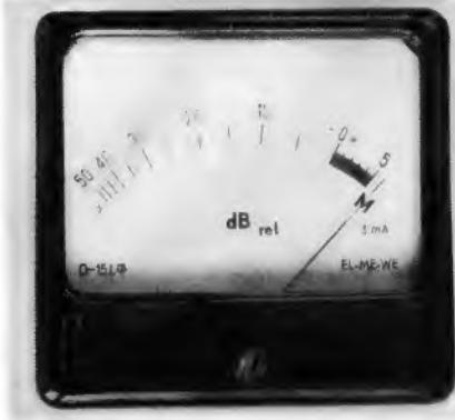
Bild 8. Skala des Aussteuerungsmessers U 703
