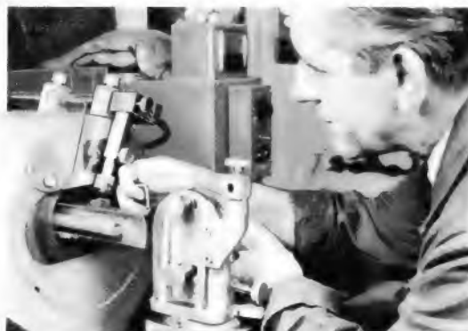
Diamant-Innensäge zum Schneiden von Siliziumtablets aus Siliziumstäben im Apparaterk München der Siemens-Schuckert-Werke
