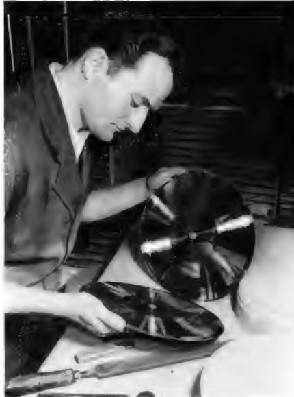
Bild 2. Die Metallmatrix wird von der Folie gelöst
