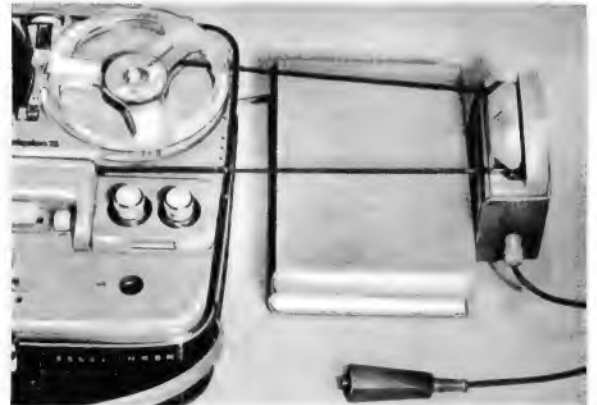
Bild 2. Zum Setzen der Bildwechselimpulse kann das Diachron-Universal in einem gewissen Abstand vom Tonbandgerät aufgestellt werden, um die Wechselzeit des Bildwerfers auszugleichen
