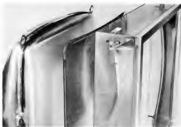
Bild 1. Demonstrationsmuster der PVC-Folie Polyflex. Rechts Demonstrationsrahmen (Maske), in der Mitte die neue Folie mit dem Federstahlrahmen, links eine handelsübliche Bildröhre mit Spannbund
