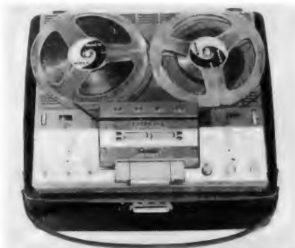
Bild 3. Uher-Royal-Stereo, ein vollständig mit Transistoren bestücktes Netzgerät für Mono- und Stereo-Aufnahme und -Wiedergabe in Vierspurtechnik
