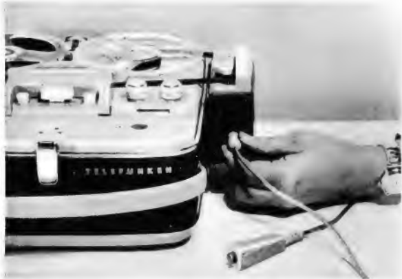
Bild 1. Das Diachron-Universal, ein neues Telefunken-Steuergerät für automatische Bildwerfer, wird seitlich neben dem Tonbandgerät angeordnet
