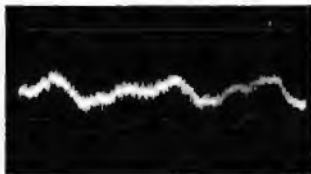
Bild 8. Oszillogramm der am 16-Ω-Ausgang des Verstärkers stehenden Brumm- und Rauschspannung bei geschaltetem Rundfunktengang und linear eingestelltem Frequenzgang
