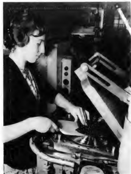
Bild 3. Füllen der Presse mit der Kunststoffmasse
