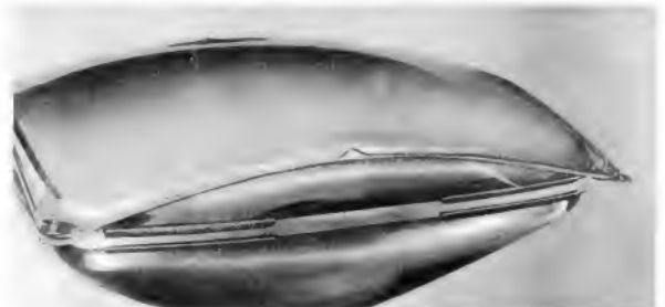
Unten: Bild 2. Bildröhre mit aufliegender Polyflex-Folie
