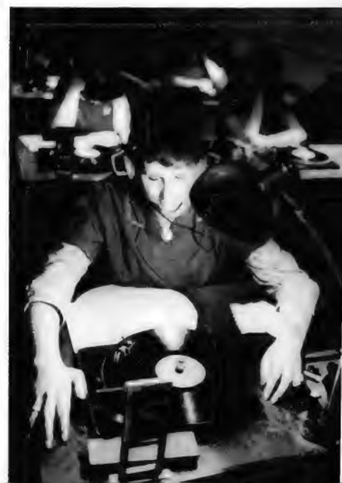
Bild 5. Der Preßrand wird abgeschliffen
