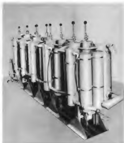
Bild 9. Fünffach-Senderweiche für die gleiche Anzahl von UKW-Rundfunksendern mit je 10 kW Ausgangsleistung
