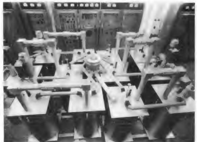
Bild 7. Für Johannesburg bestimmte 6fach-Senderweiche HD 9032/106 für die gleiche Anzahl von 10-kW-Rundfunksendern auf dem Prüfstand im Werk
