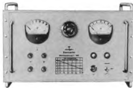
Modell 3: 5 V, 12 A bis 66 V, 5,4 A Modell 3B: 3 V, 22 A bis 36 V, 12 A
