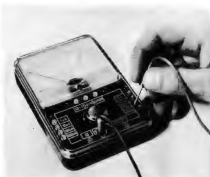
Bild 1. Die Meßbereiche werden durch Umstecken gewählt
