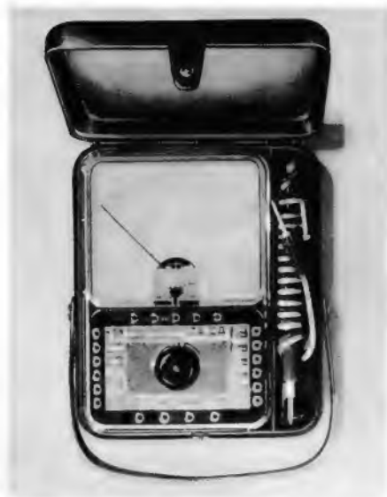
Bild 7. Ein Transportkästchen schützt das Instrument (hier der vielseitigere Typ 68C) und nimmt auch die Meßschnüre auf
