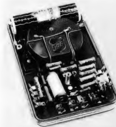
Bild 6. Die Schaltungen Bild 2 bis 4 sind auf kleinstem Raum übersichtlich untergebracht, oberhalb des Instruments ist die 3-V-Batterie untergebracht
