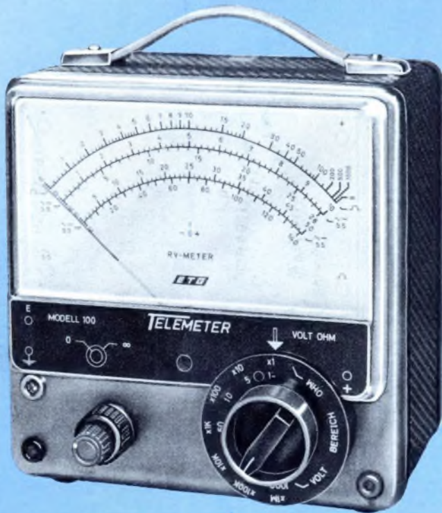
TELEMETER 100. Elektronisches Volt-Ohm-Meter für Gleich-, Wechsel- und \Omega -Spannungen. 1 V - 1000 V S.E. 32 Meßbereiche. Standardeingangswiderstand 11 M \Omega . (Großes Meßwerk), 130 mm Zeigerweg.
