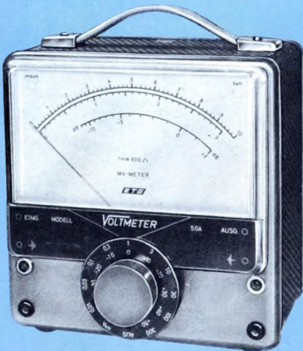
VOLTMETER 50 A. NF-Millivoltmeter. 10 mV - 300 V eff S.E. Frequenzgang 10 Hz - 50 kHz. Gleichspannung stabilisiert. dB-Skala von -10 dB bis +2 dB. dB-Bereiche von -40 bis +50 bezogen auf 1 mW/600 \Omega . (Großes Meßwerk), 130 mm Zeigerweg.
