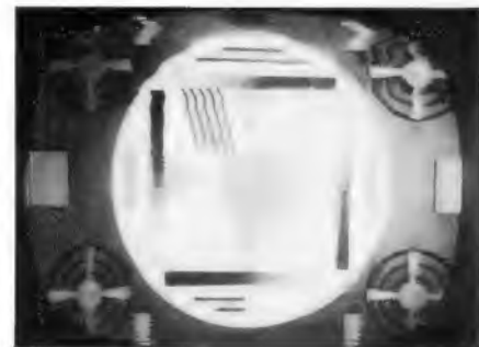
Bild 3. Regelschwingungen entstehen infolge ungenügender Siebung der Regelspannung für den Zeilengenerator
