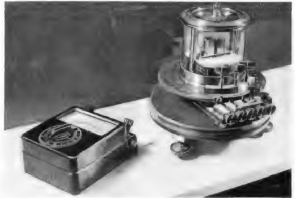
Das erste Betriebs-Meßinstrument, das Universal-Galvanometer aus dem Jahre 1868 von Werner von Siemens (rechts), neben einem neuzeitlichen Siemens-Vielfachinstrument (links)
