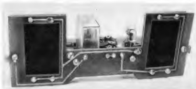
Rechts: Bild 1. Das einbaufertige Lichtrelais; links und rechts die rechteckigen Selenzellen, in der Mitte das Relais
