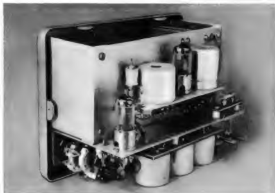
Bild 6. Blick auf die Rückseite der senkrechten Montagewand mit der Oszillatorkonsole. Auf dieser, von links nach rechts: der Trimmer von C _9 , L _7 , R \ddot{0} 1, Elektrolytkondensator des Netzteiltes; links unten R \ddot{0} 2, darunter drei Spulensätze der Meßkreise
