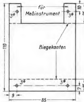
Bild 12. Abwicklung der U-förmigen Montagewinkel (2 Stück)
