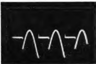
Bild 2b. Deutliche Hysterese eines Schmitt-Triggers. Der absteigende Teil der Sinuskurve löst die Umschaltung bei einem negativeren Potential aus als der ansteigende Teil
