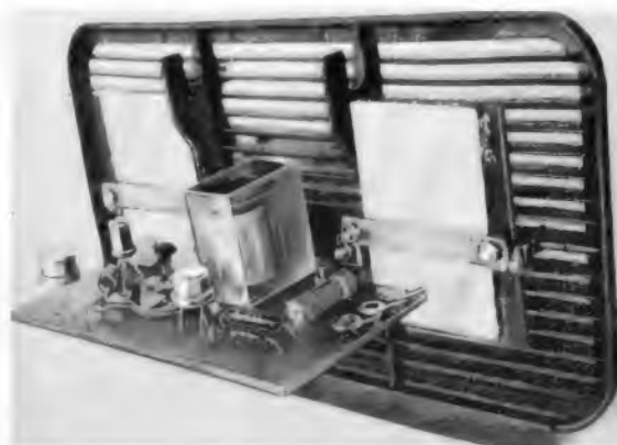
Bild 3. Das fertige Gerät an der Rückseite einer Lautsprecherabdeckung montiert
