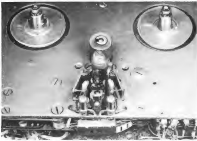
Bild 26. Die fertig montierten Köpfe
