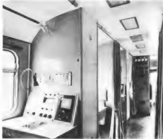
Der Eurovisionswagen enthält zehn Tonmischplätze, die durch schallschluckende Vorhänge abgeteilt werden. Außerdem führt er zusammenlegbare Sprechkabinen mit
