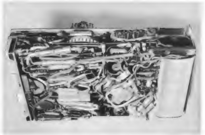
Bild 31. Eingebauter Verstärker im senkrecht stehenden Gerät
