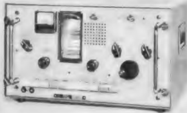
Bild 4. Transistorisierter Such- und Überwachungsempfänger für Funkstationen mit zehn Wellenbereichen Modell E 639 von Telefunken
