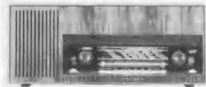
Bild 4. 7-Röhren-Großsuper Comedia von Graetz mit drei Lautsprechern
