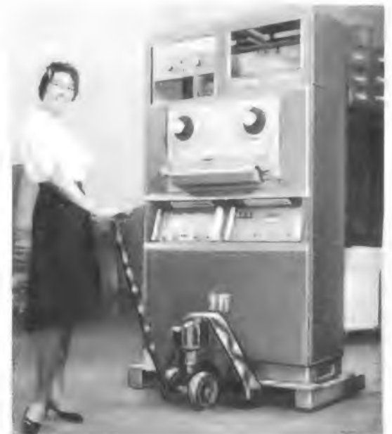
Bild 1 Ampex-Kompakt-Videogerät beim Transport vom Fernsehstudio zum Aufnahmewagen für Freiübertragungen bzw. Aufzeichnung
