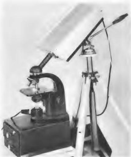
Bild 1. Kompakt-Fernsehkamera von Philips zum Übertragen von mikroskopischen Präparaten auf den Fernsehbildschirm
