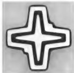
Bild 1. Sterngeometrie des Epitaxial-Planar-Transistors (von innen nach außen: Emitter, Basis, Kollektor)
