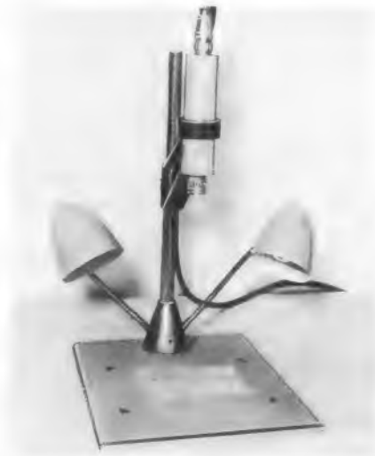
Bild 2. Fernauge FA 30 für sehr feine Auflösung bei Dokumentenübertragung mit 875 Zeilen (Grundig)
