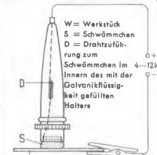
Bild 2. Anschließen des Galvanisiergerätes Chrom-Fix
