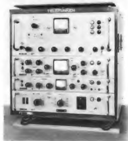
Bild 5. Fernbedienbarer Steuervorsatz für Grenz- und Kurzwellensender VSS 676/1 (1,5...30 MHz) von Telefunken
