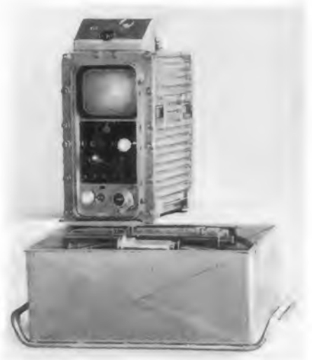
Bild 3. Schlagwettergeschützte Fernseh-Übertragungsanlage für den Bergbau; vor dem Monitor im Kasten die Kleinstkamera (Ibak, Kiel)
