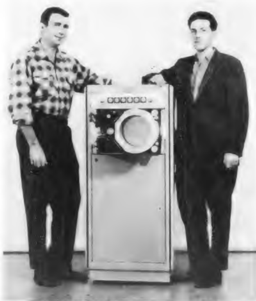
Bild 2. In der Mitte das kaum 13,5 kg schwere Miniatur-aufzeichnungsgerät von Ampex, hier auf ein Prüfgestell montiert, flankiert vom Erfinder Alex Maxey (links) und Projekt-Ingenieur Alan Grace
