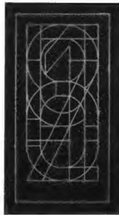
Bild 15. Elektro-Lumineszenz-Platte zur Anzeige von gut lesbaren Ziffern (Optronik)
