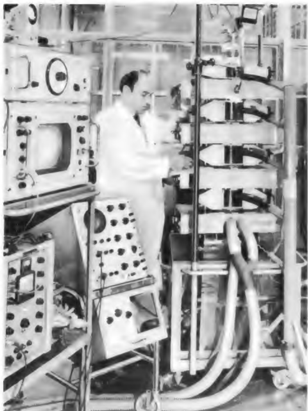
Bild 8. Prüfung des neuen Vierkammer-Klystrons YK 1001 mit Druckluftkühlung und neuartigen Ferroxdure-Magneten (Valbo)
