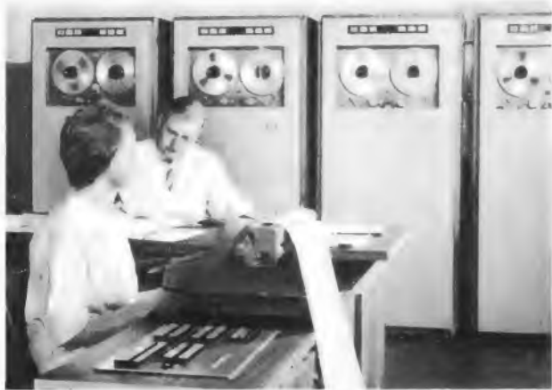
Bild 14. Bedienungspult der Digital-Großrechenanlage TR 4; im Hintergrund Magnetbandspeicher MDS 251 mit Siebenspuraufzeichnung auf 1/2-Zoll-Band. Jede Spule enthält 1080 m Band, ausreichend für 10 7 Zeichen (Telefunken)
