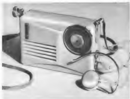
Bild 12. Empfangsgerät für Teleton von Tonfunk mit Anschlußmöglichkeit für zwei Kleinsthörer
