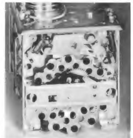
Bild 11. VHF-Kanalwähler mit gespeicherter Feinabstimmung mit Zahnsegmenten und Kurvenscheibe im Chassis F 33 von Siemens
