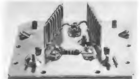
Bild 2. Die Universal-Ringweiche für Bereich III entkoppelt zwei benachbarte Kanäle (Fuba)
