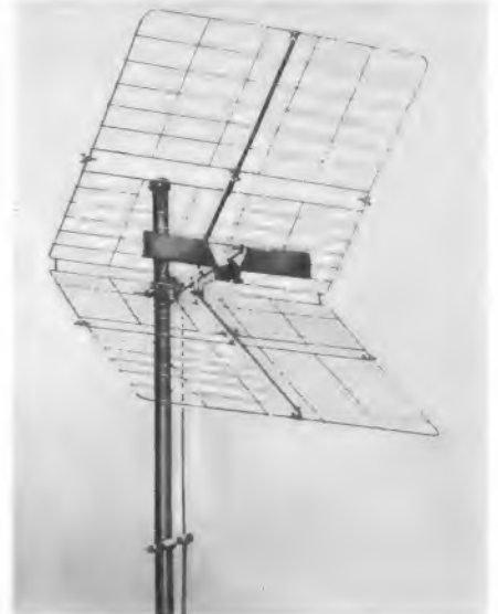
Bild 3. Breitband-UHF-Antenne Corner 3 von Hirschmann. Der kleine Koppelstab vor dem Flächendipol hebt die Empfindlichkeit an der oberen Bereichsgrenze an
