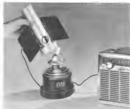
Thermoelektrischer Generator für kleine Rundfunkgeräte von 3 M
