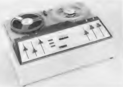
Bild 12. Heimstudio-Tonbandgerät mit Flachbahnreglern (Elektron)
