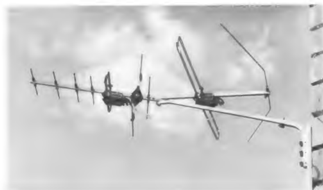
Bild 8. Eine VHF/UHF-Kombination als Fensterantenne. Beide Teile sind einzeln auszurichten (Zehnder)
