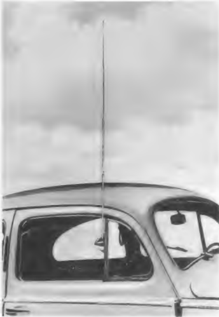
Bild 5. In die Scheibenführung des Seitenfensters kann die Teleskop-Antenne P 171 von Poddig ohne Behinderung der Lüftung eingeschoben werden
