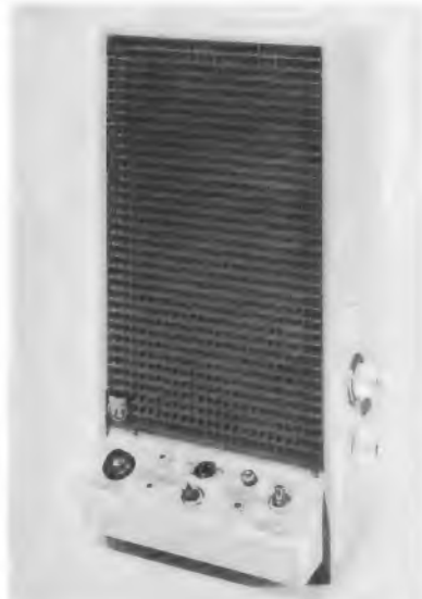
Bild 9. Der Werkstatt-Prüferverstärker für Abspielgeräte von PE
