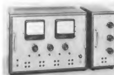
Bild 13. Meßgerät für Frequenzschwankungen Typ EMT 420, rechts daneben das umschaltbare Hoch- und Tiefpaßfilter
