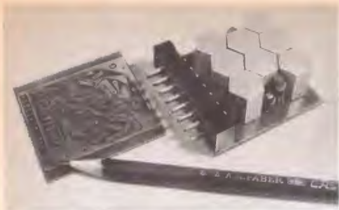
Bild 3. Mehrere Mikromodul-Bausteine sind auf einer gedruckten Schaltplatte vereinigt
