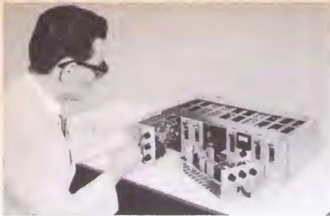
Der Grundig-Stereo-Rundfunk-Modulator, wie er für die derzeitigen Stereo-Rundfunk-Versuchsendungen des Instituts für Rundfunktechnik (Homburg) verwendet wird
