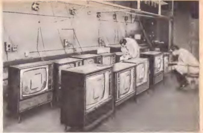
Bild 1. Ein „tragbarer“ Fernsehempfänger (Gewicht 24 kg) wird mit Hilfe eines Laborsenders auf Bildqualität untersucht
