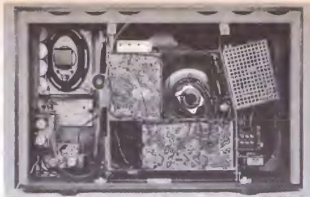
Bild 5. Metz-Mallorca bei abgenommener Rückwand. Das Chassis ist in zwei Druckplatten und den Hochspannungskäfig aufgeteilt. Die Eingangsstufen befinden sich links unterhalb des Lautsprechers
