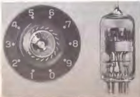
Bild 11. Zum leichteren Ablesen wird um die dekadische Zählröhre EZ 10 B ein Ziffernring gelegt
