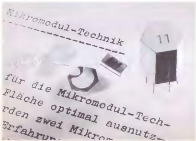
Bild 1. Mit der Mikromodultechnik kann ein Raumgewinn von 1 : 10 gegenüber der Bauweise mit Kleinstelementen erzielt werden. Links im Bild die einzelnen Mikromodulplättchen, rechts daneben das Mikromodul fertig vergossen
