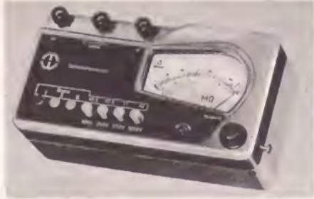
Bild 9. Ein batteriebetriebener Isolationsmesser mit Meßspannungen bis zu 1000 V der Metrawatt AG
