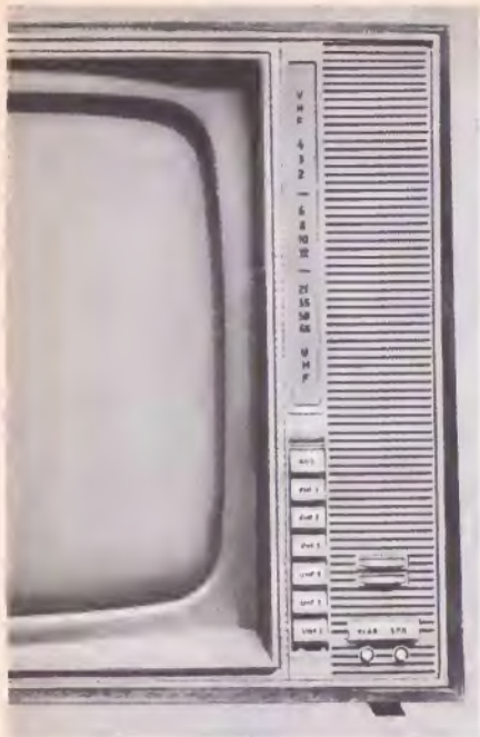
Bild 5. Endgültige Ausführung der Leuchtskala im Telefunken-Fernsehempfänger FE 242 T
