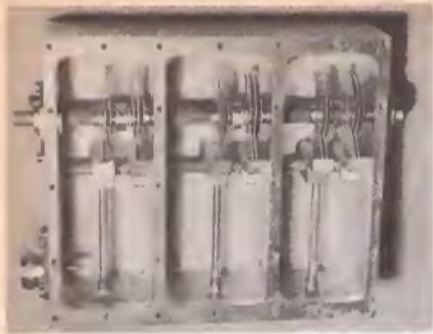
Bild 8. Abstimmteil der Schaltung von Bild 6. Der Rotor ist auf einer Keramikdose befestigt, einer der Statoren ist großflächig gaserdet
