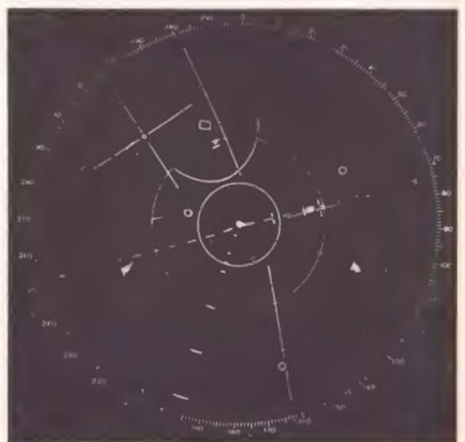
Bild 4. Das gleiche Schirmbild wie in Bild 3, jedoch mit Festzielunterdrückung, so daß bewegliche Ziele weitaus besser erkennbar sind
