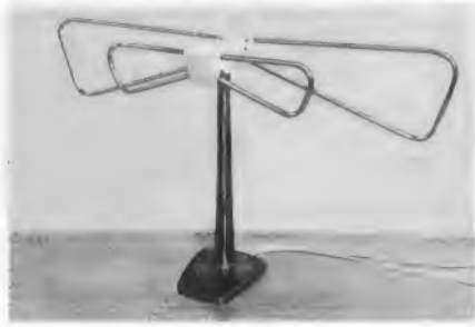
Bild 1. Fernsehantenne Typ Eltronik-Diplex mit getrennten Dipolen und Zuleitungskabeln
