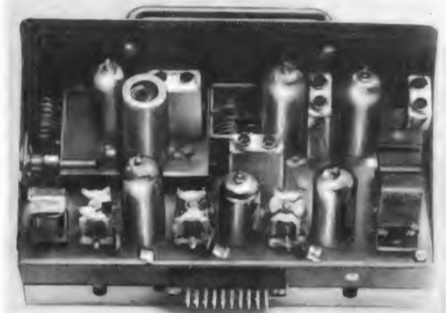
Bild 9. Chassisaufsicht des Hf-Teils. Am rechten Schmetterlingsdrehkondensator ist die Symmetriekapazität C_s zu erkennen, hinten links die Antennenspule
