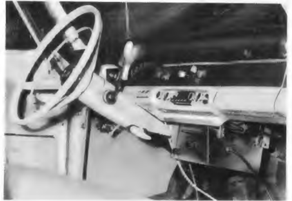
Bild 1. Das Funksprechgerät unter dem Armaturenbrett
