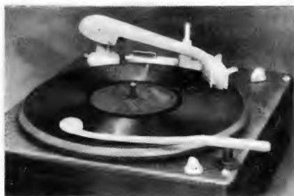
Bild 1. Ein Plattenspieler mit dem zusätzlich aufgesetzten Rexion-Staubwischerarm im Vordergrund
