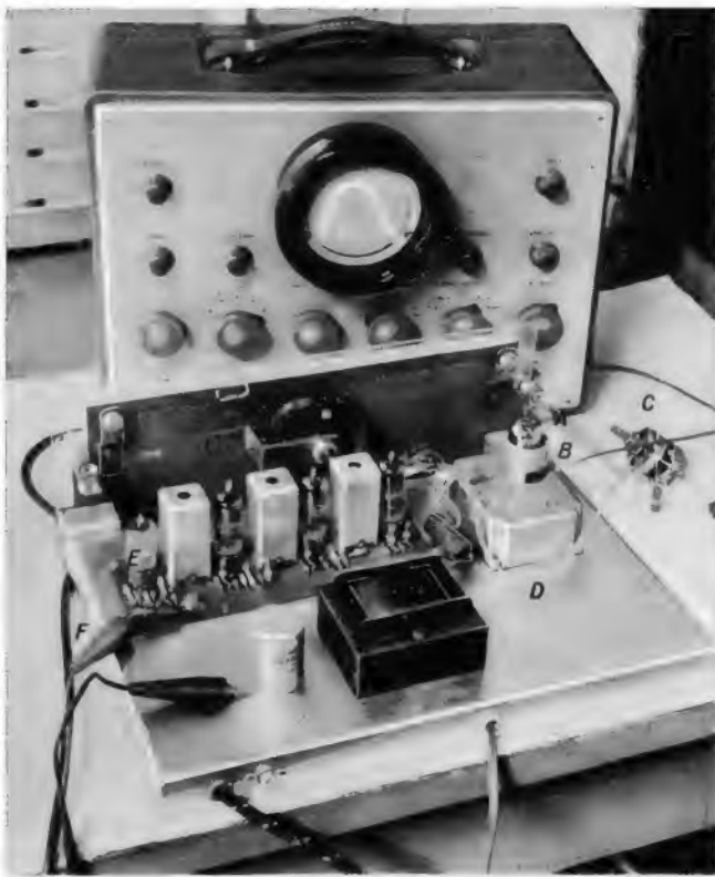
Bild 3. UKW-Empfänger und Oszillograf – das ist alles, was zu einem kunstgerechten Schirmbild-Abgleich nach dem neuen Verfahren benötigt wird. Die Eingangsspannung wird der Antenne entnommen; gewobbelt wird der Empfänger-Oszillator über seine eigene Nachstimm-Schaltung. Auf dem Schirm sieht man eine Zf-Durchlaßkurve bei Verwendung der 50-Hz-Lichtnetzspannung zur Horizontal-Ablenkung
