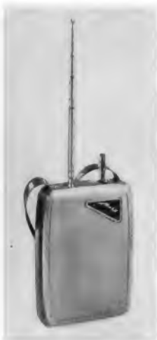
Bild 1. Metz-Mecatron-Dreikanalsender für die Modellfernsteuerung
