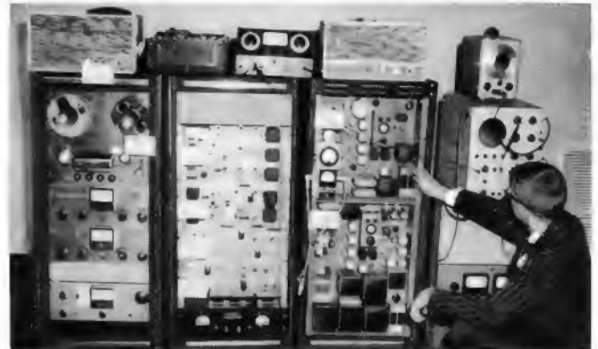
Bild 2. Versuchsaufbau eines vollständigen Stereo-FM-Senders nach der neuen Norm mit Stereo-Tonbandgerät (links oben) und Tonbandgerät für SCA-Signale (links außen)
