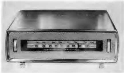
Der neue Grundig-UHF-Konverter UC 1. Die beiden Bügel an der Unterseite des vernickelten Frontrahmens dienen zum Einhängen in die Rückwand des Fernsehempfängers, so daß der Konverter von oben bedient werden kann
