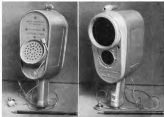
Das Infraphone-Lichtsprechgerät; links von der Einsprache-Seite, rechts Sende-Scheinwerfer und Aufnahmeoptik. Oben am Gehäuse der Peilsucher. – Siehe auch den Kurzbericht in Heft 10, Seite 250 „Funksprechgeräte für Infrarot und Ultraviolett“
