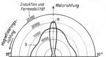
Bild 1. Richtungsabhängigkeit der magnetischen Eigenschaften von orientiertem Transformatorblech Typ Armco M 6; a = Permeabilität bei Flußdichte B_{max} = 1,5 \text{ Wb/m}^2 , b = Flußdichte bei Feldstärke H_{eff} = 8 \text{ A/cm} (konst.)
