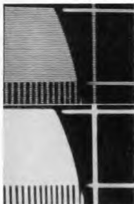
Wirkung der Sabavision-Scheibe. Oben: Ausschnitt aus einem Testbild, unten: dgl., jedoch mit vorgesetzter Sabavision-Scheibe. Die Zeilenstruktur ist verschwunden!
