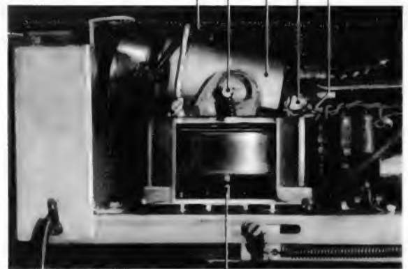
Bild 3. Seitenansicht des Antriebsmotors mit dem Schwungmassenring. Der Antriebsmotor ist hier mit seinem Zapfen T in die linke Endstellung des halbrunden Lagerausschnittes gebracht worden. Dadurch liegt der kleinere Wellendurchmesser G auf dem Reibrad der Schwungmasse auf. Sitzt der Zapfen T rechts im Ausschnitt, dann ist die dickere Welle F im Eingriff (vgl. Bild 2)
