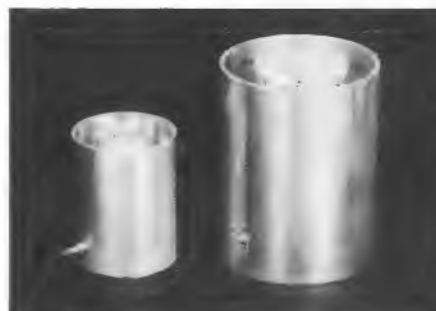
Bild 7. Links ein Kreis für f = 16 MHz, Q = 500 , D = 76 mm; rechts ein Kreis für die gleiche Frequenz mit Q = 850 und D = 115 mm. Die Kreise wurden durch Parallelkapazitäten abgeglichen
