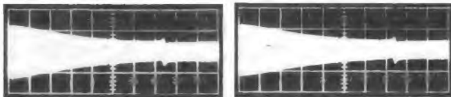
Bild 11. Oszillogramme der Frequenzkurve eines Transistorverstärkers. Sie zeigen scharf ausgeprägte Resonanzstellen, die bei der punktreisen Aufnahme der Kurve wahrscheinlich übersehen worden wären
