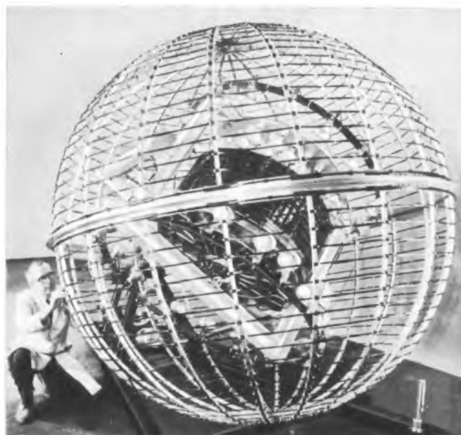
Erdsatellit Tiros II für die Großraum-Wetterbeobachtung mit zwei Kameras und Bildentwicklungs- und -sendeanlage wird hier vor seinem Start in einem Käfig geprüft, der das Magnetfeld der Erde im Weltraum nachbildet. Starke Lampen dienen der Funktionsprüfung der 9260 Siliziumzellen („Sonnenbatterien“)
