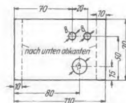
Bild 12. Generator-Chassis, Aluminium 1,5 mm
