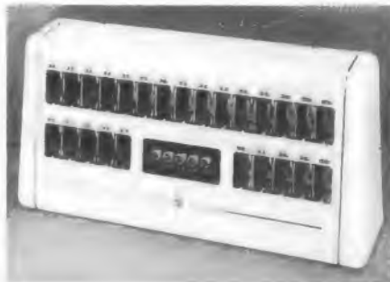
Bild 3. Das Ablageregale fur die Empfanger steuert automatisch die „Anwesenheitslampen“ und fuhrt die Batterie-Reaktivierung aus
