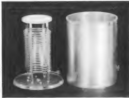
Bild 4. Wendel-Topfkreis für f = 18,7 MHz, Q = 820 , D = 115 mm, b = 2 mm. Mit kapazitiver Last ergibt sich f = 16 MHz, Q = 850 . — Links die Wendel auf einem sehr verlustarmen Spulenkörperskelett, rechts der Topf
