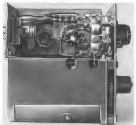
Rechts: Bild 21. Blick von unten in die Verdrahtung. Glühlampe und Abschirmhaube des Schalters entfernt
