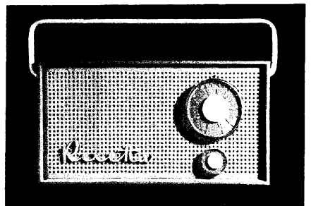
Bild 2. Taschensuper Rexetta mit Reflexschaltung
