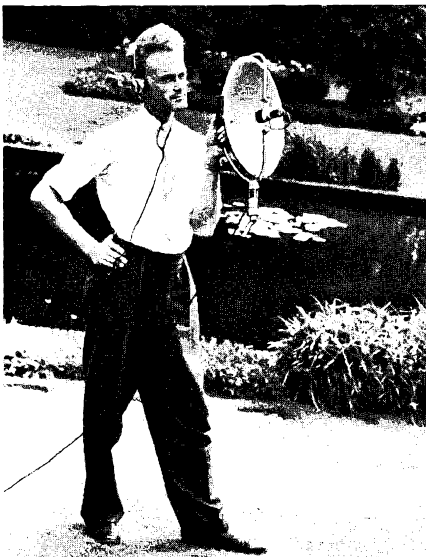
Bild 9. Parabelmikrofon mit Reflektor (Eigenkonstruktion der Nederlandsche Radio Unie, Hilversum)
