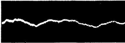
Bild 6. Oszillogramm der Brumm- und Rauschspannung des VKS 203 bei linear eingestelltem Frequenzgang
