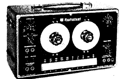
Bild 5. AM/FM-Signalgenerator Radiotest MS-5 (Klein & Hummel)
