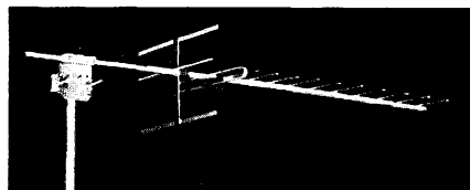
Bild 3. Siemens-Band-IV-Antenne SAA 137 mit 14 Elementen, in Längsrichtung um \frac{1}{4} \lambda verschiebbar
