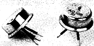
Bild 12. Legierter pnp-Germanium-Leistungstransistor AD 105 von Siemens für Nf-Verstärker und als Schalter für hohe Leistungen
