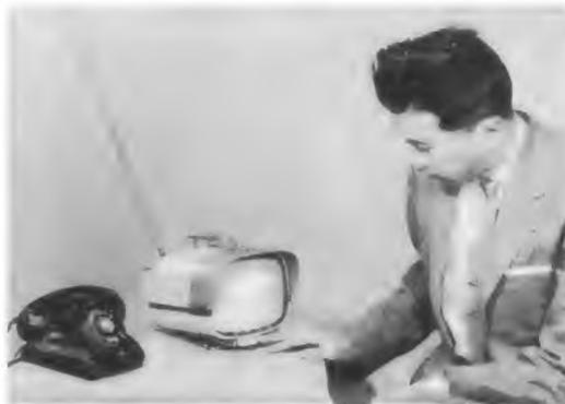
Volltransistor-Fernsehempfänger Sony 8-301 für Batteriebetrieb und Netzanschluß 110 V
