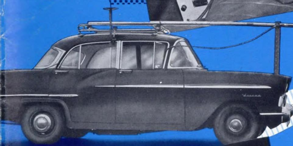
Die Fernsehkamera blickt unter das fahrende Auto und überträgt das Spiel der Lenkung und Federung auf das Fernsehgerät im Innern des Wagens. Aufn.: Vauxhall Motors Ltd.
