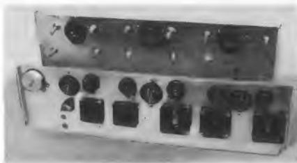
Bild 29. Vorder- und Rückansicht der elf gleichen Querwände
