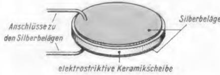
Bild 1. Aufbau eines elektrostriktiven Elements
