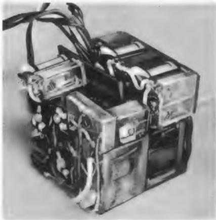
Bild 4. Empfängerblock mit Blick auf die eigentliche Empfangsschaltung
