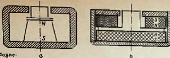
Bild 7. Streuarne Topmagnet-Systeme: a) mit Stahlmagnet, b) mit Bariumferrit-Magneten
