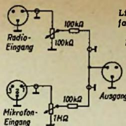
Links: Bild 1. Das einfache Mischpult mit zwei Eingängen für Mikrofon und Radio
