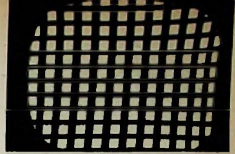
Bild 1. Verzerrungen eines Fernseh-Testbildes durch das Streufeld eines Lautsprechers
