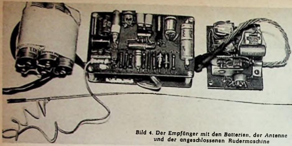
Bild 4. Der Empfänger mit den Batterien, der Antenne und der angeschlossenen Rudermaschine
