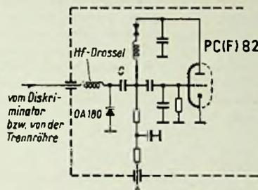
Bild 2. Ankopplung der Nachstimm-diode an den Empfängersoszillator
