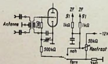
Die gleichstrommäßig auf Masse liegende Antennenspule hatte Verbindung mit der Gitterspule und konnte die Regelspannung hinter dem 500-kΩ-Widerstand nach Masse kurzschließen. Die fehlende Regelspannung war die Ursache für die Übersteuerung der Eingangsröhre und für die Beschneidung der Synchronisierimpulse
