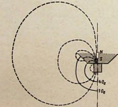
Bild 11. Streufeld eines Lautsprechers mit Bügelmagnet-System (nach Bild 3). Es ist der magnetische Ersatzdipol eingezeichnet, der ein gleiches Fernfeld erzeugen würde
