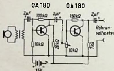
Schaltung eines Transistor-Schalldruckmessers zum Anschluß an ein Röhrenvoltmeter
