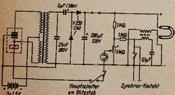
Bild 1. Der Zerhacker des Blitzgerätes Hoptronic 30 wird aus Monozellen betrieben
