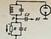
Bild 26. Hf-Gleichrichter; die Richtspannung wird am Fußpunkt des Schwingkreises abgenommen
