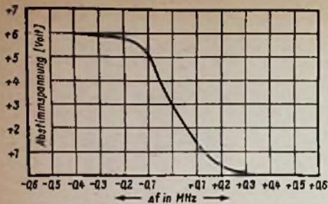
Bild 6. Verlauf der Abstimmspannung
