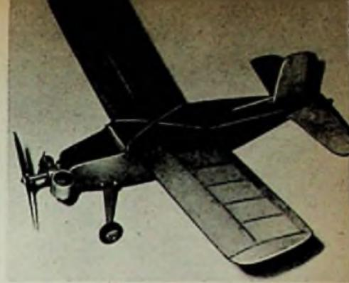
Bild 1. Das kleinste der mit dieser Anlage ausgerüsteten Flugmodelle; Spannweite 66 cm, Gewicht 480 g, Diesel-Motor 0,8 ccm
