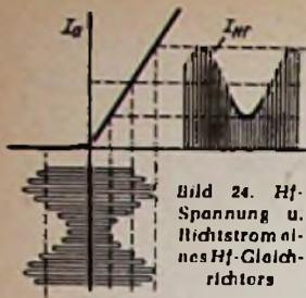
Bild 24. Hf-Spannung u. Lichtstrom eines Hf-Gleichrichters
