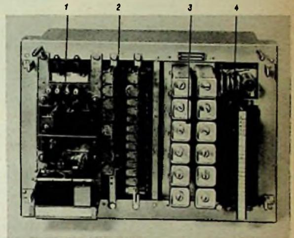
**Bild 3. Steuer- und Verstärkeranlage ST 16 (ohne Abdeckhaube); 1 = Speiseteil, 2 = Relaisenteil, 3 = Oszillatorteil, 4 = Verstärkerteil**
