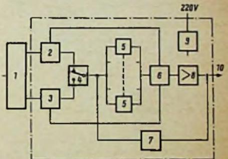
**Bild 4. Prinzipschaltung der Steuereinrichtung; 1 = Anschalteneinrichtung (bei mit Telefonanlagen kombinierten Anlagen) bzw. Gebereinrichtung (bei von der Telefonanlage unabhängigen Anlagen), 2 = Zehner-Oszillator-Markierrelais, 3 = Einer-Oszillator-Markierrelais, 4 = Umschalter, 5 = Oszillator 1...6 bzw. 1...12, 6 = Oszillator-Freigabereleais, 7 = Schlaufabstimm-Kriterium, 8 = Verstärker, 9 = Speiseteil, 10 = Steuerleitungen zu den Schlaufverstärkern**
