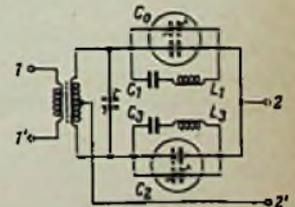
Bild 6. Vollständige Quarzbrückenschaltung. Die einzelnen Elemente sind entsprechend den Dimensionierungsformeln bezeichnet
