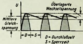
Bild 20. Ausgleich der Stromstöße durch einen Ladekondensator
