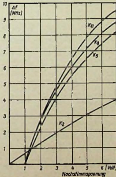
Bild 3. Frequenzänderung des Oszillators durch die Nachstimmspannung
