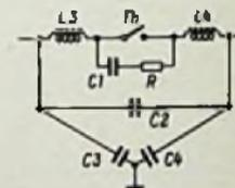
Bild 3. Eine Störschutzschaltung für höchste Ansprüche. T = Thermokontakt, L 3 und L 4 sind UKW-Siferit-Kern-Drosseln,  $C_1 < 0,5 \mu$ F,  $R = 30 \dots 100 \Omega$ ,  $C_2 = 0,1 \mu$ F, C 3 und C 4 je 2,5 nF, als Berührungsschutzkapazität ausgeführt
