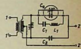
Bild 9. Schaltung eines Filters mit nur einem Quarz
