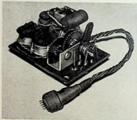
Bild 5. Der Höhenrudermotor. Man erkennt die Relais 3 und 4, das Getriebe 60 : 1, die Schaltlocke mit den Federn und dahinter den Elektromotor; Gewicht: 45 g
