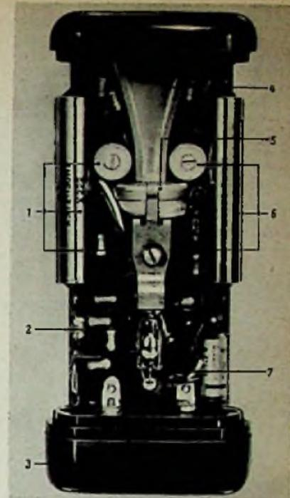
Bild 10. Rufempfänger RE 16 (ohne Gehäuse und Aufnahmespule); 1 = Quarzfilter 1, 2 = Quecksilberschalter, 3 = Batterietaste, 4 = Hornstrahler, 5 = Elektroakustischer Wandler, 6 = Quarzfilter 2, 7 = Rufoszillator
