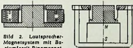
Bild 2. Lautsprecher-Magnetsystem mit Bariumferrit-Ringmagnet
