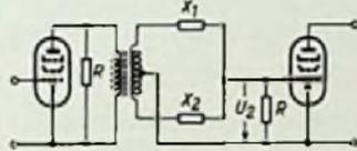
Bild 4. Einschaltung der Differentialbrücke
