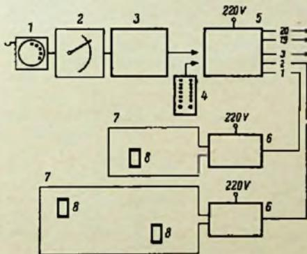
**Bild 2. Prinzipschema einer drahtlosen Personensuchanlage; 1 = Teilnehmerapparat der automatischen Telefonanlage, 2 = automatische Telefonzentrale, 3 = Anschalteneinrichtung (nur bei Suchanlagen, die mit der Telefonanlage kombiniert sind), 4 = Gebereinrichtung (nur für Suchanlagen), 5 = Steuereinrichtung, 6 = Schlaufverstärker, 7 = Induktionsschleife, 8 = Rufempfänger**
