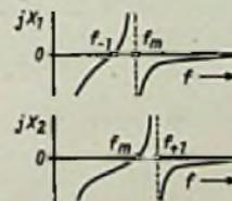
Bild 5. Verlauf der Quarzreaktanzen. Parallelresonanz von  $X_1$  und Serienresonanz von  $X_2$  liegen in Bandmitte. Die Serienresonanz von  $X_1$  und die Parallelresonanz von  $X_2$  bilden die Grenzfrequenzen
