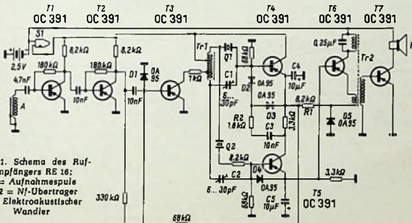
Bild 11. Schema des Rufempfängers RE 16; A = Aufnahmespule, Tr 2 = Nf-Übertrager, H = Elektroakustischer Wandler
