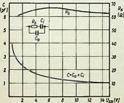
Bild 1. Abhängigkeit der Sperrschicht-Kapazität von der Sperrspannung
