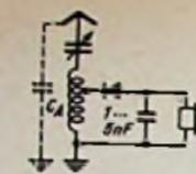
Bild 25. Schaltung eines einfachen Detektorempfängers
