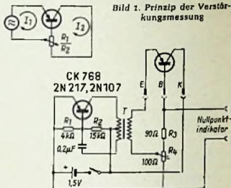
Bild 2. Schaltung eines durch einen Tongenerator gespeisten Verstärkungs-Meßgerätes
