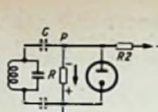
Bild 27. Die Richtspannung wird an der Diodenanode abgenommen
