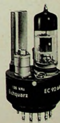
Bild 5. Der als Einsteckeinheit (für eine zehnpolige Stahlröhrenfassung) ausgeführte Eichgenerator
