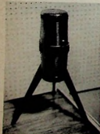
Eine interessante Mikrofon-Konstruktion, das Telefunken Mikrofon D 77 Stereo für zweikanalige Tonaufnahme. Es besteht aus einem ausgesuchten Pärchen von zwei Nierenkapseln. Sie sind um 60...180° drehbar. Durch Lösen einer Druckknopf-Verbindung können die beiden Kapseln bis auf eine Basisbreite von 2,40 m auseinandergestellt werden.
