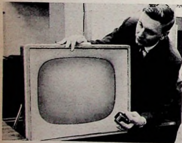
Russischer Fernsehempfänger mit herausklappbarer Bildröhre und Fernbedienung auf der russischen Ausstellung in New York
