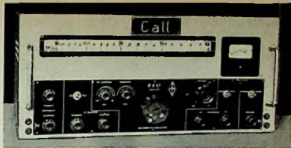
Bild 1. Die Frontplatte des Emp-fängers RX 57 mit dem Stations-Rufzeichen, der beleuchteten Wal-zenskolo, dem S-Motor und den übersichtlich beschrifteten Bedie-nungsorganen
