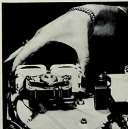
Bild 11. Telefunken-Plattenspieler-Chassis TP 5 mit indirektem Antrieb und an drei Spiralfedern frei aufgehängtem Motor
