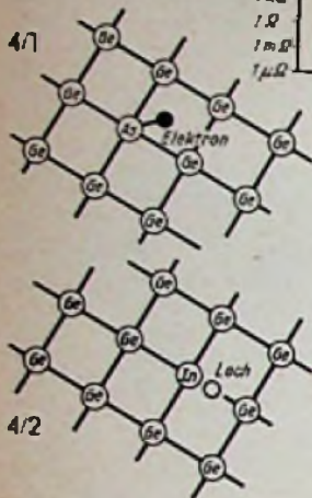
Bild 4. Germanium-Kristallgitter mit Störstellen. 4/1 = Ein Arsen-Atom besitzt ein überzähliges negatives Elektron. 4/2 = Bei einem Indium-Atom fehlt ein Elektron, es entsteht ein Loch
