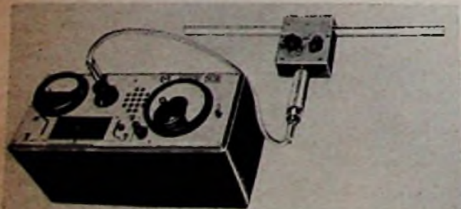
Bild 7. Tragbares und batteriegespeistes Siemens-Transistor-Betriebsstörmeßgerät 150...3000 kHz
