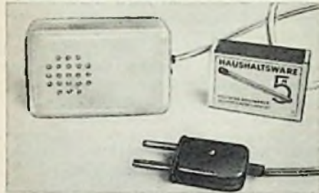
Bild 1. Das magnetische Transistormikrofon ist wenig größer als eine Streichholzschachtel
