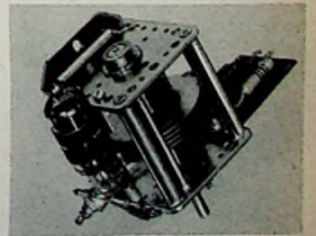
Bild 3. Der neue Philips-Oszillator-Baustein PP 1105 wird gegen den im Meß-Sender GM 2889 vorhandenen ausgetauscht und schafft einen erweiterten Frequenzbereich von -70 über 0 bis 280 MHz und von 470 bis 800 MHz
