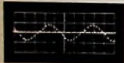
Bild 10. Oszillogramm zu Bild 7 am Punkt a. Es stellt das aus A und B gemommene Signal A vor dem Integrierglied dar
