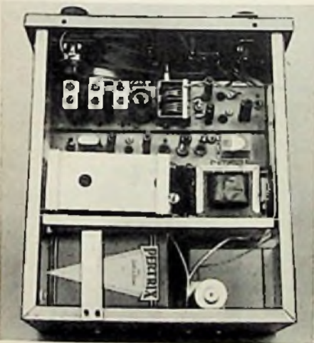
Bild 7. Aufsicht auf das 2-m-Funksprechgerät. Oben das Empfängerchassis, darunter das Senderchassis, darunter der Spannungswandler mit der Nf-Endstufe. Rechts ganz unten die Zeltbatterie
