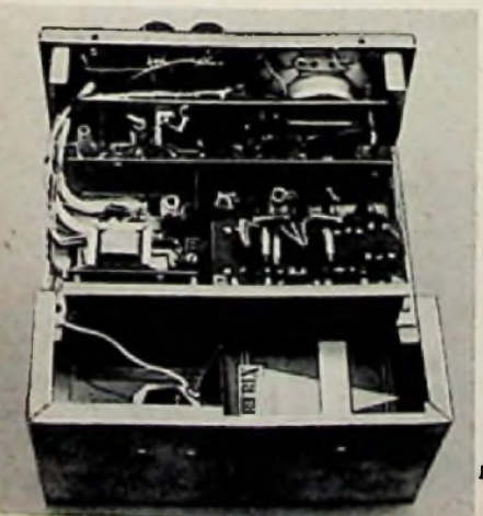
Bild 7. Aufsicht auf das 2-m-Funksprechgerät. Oben das Empfängerchassis, darunter das Senderchassis, darunter der Spannungswandler mit der Nf-Endstufe. Rechts ganz unten die Zeltbatterie
