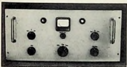
Bild 1. Auf der Frontseite des als Einschub aufgebauten Speisegerätes sind die Bedienungorgane übersichtlich angeordnet
